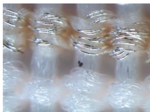
Obr. 6 Detail vodivé dráhy ve stuze.
