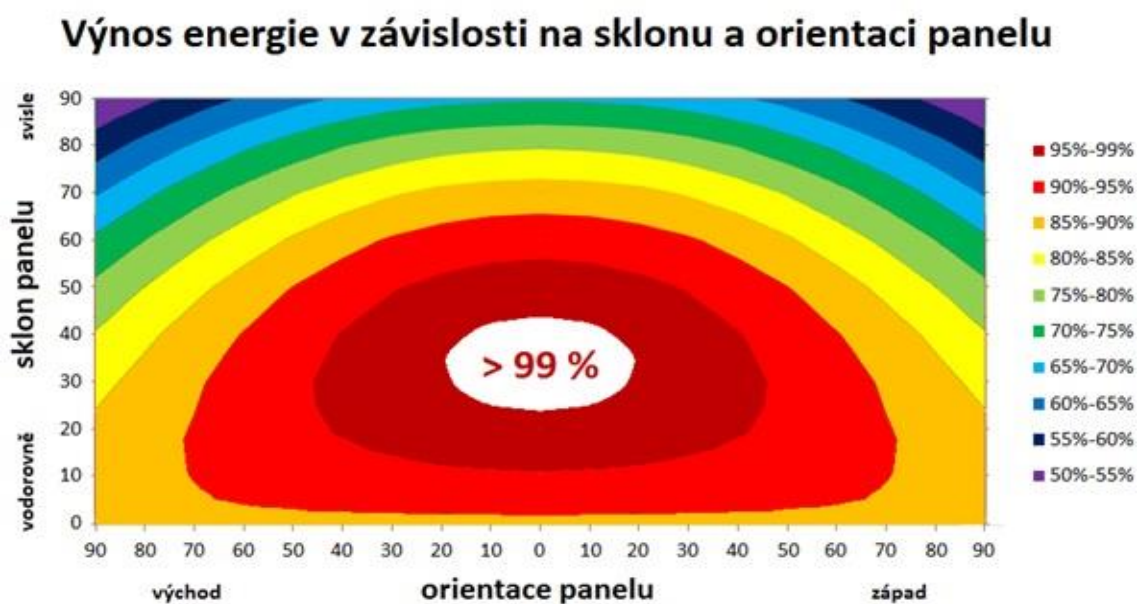
Obr. 1.2 Výnos energie v závislosti na sklonu a orientaci panelu [5]
