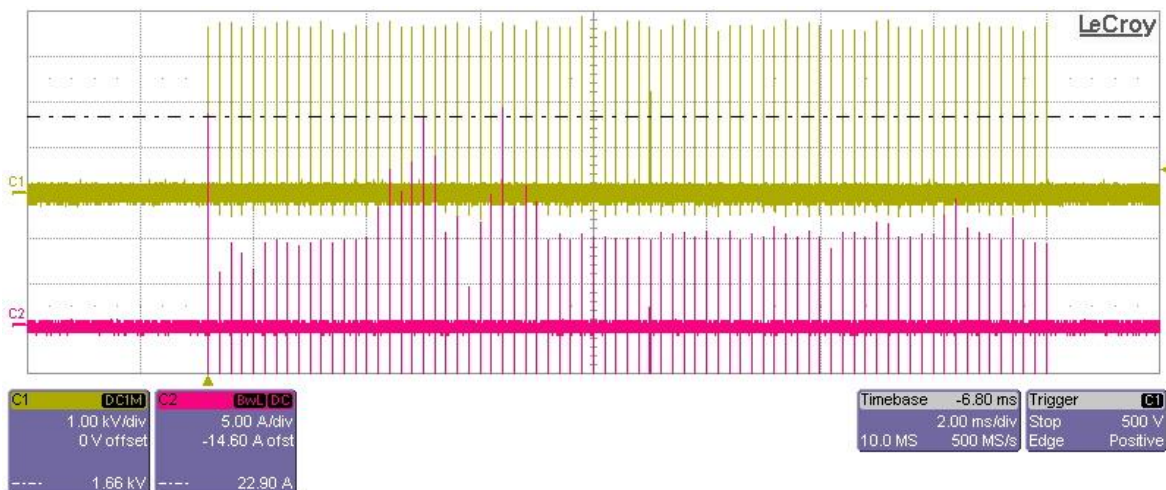
Obr. 54 Burst test na jiskřišti EPCOS 230030 při 4 kV impulzech
