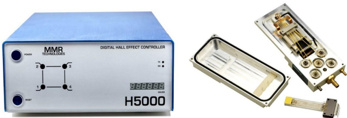
Obr. 4.6: Měřicí ovladač Hallova jevu a van der Pauwovy metody (vlevo) a vakuová komora se čtyř-hrotovou sondou (vpravo) [12].
