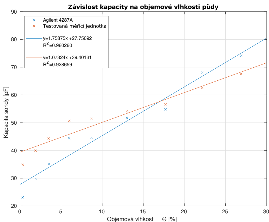
Obrázek 10.1: Kalibrační závislost kapacity na objemové vlhkosti půdy
