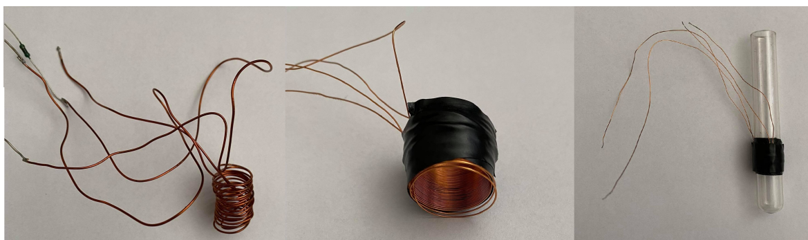
Obrázek 21 Vývojové verze sond pro měření permeability
