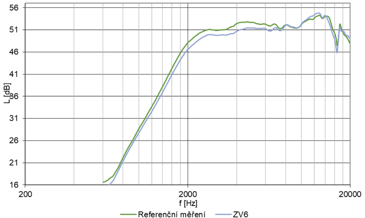
Obr. 4.7: Porovnání referenčního měření reproduktoru a reproduktoru se zvukovodem 6 mm
