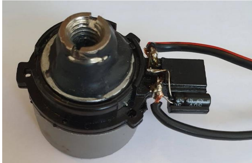
Obr. 3.6: Uchycení reproduktoru ke stativu
