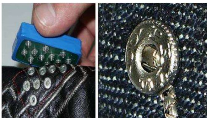
Obr. 1.7: Příklady rozpojitelných spojení – druky (vlevo) a patentky (vpravo) (převzato z [86])
