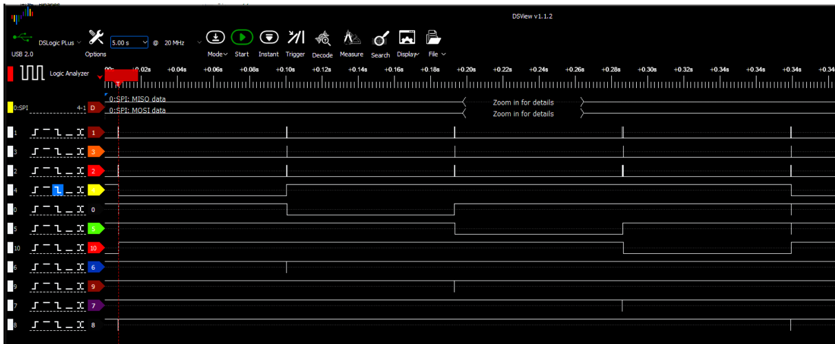
Obrázek 4.1: Průběh komunikace SPI během měření 4 senzorů (DSView)
