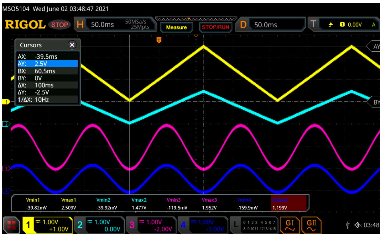
Obrázek 4.10: Ch.1 (žlutá) - napětí na J4(1), Ch.2 (tyrkysová) - napětí na AIN19, Ch.3 (růžová) - napětí na J4(9), Ch.4 (modrá) - napětí na AIN16
