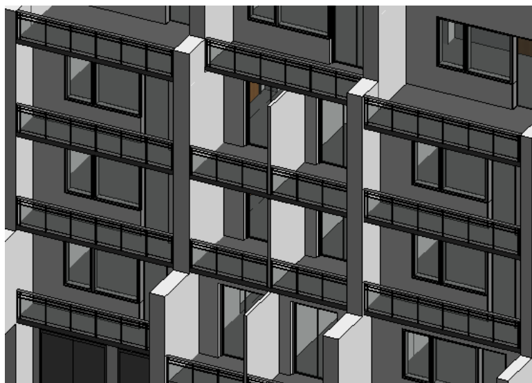
Obrázek 2.11 - Ukázka zábradlí na balkonech
