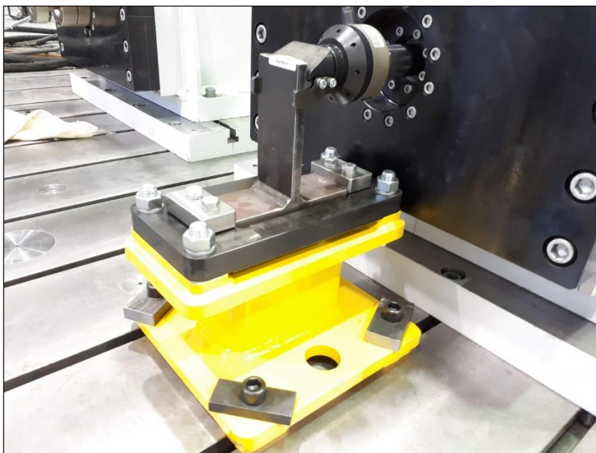
Obr. 59 – Zkušební stend pro zkoušky T-vzorků s koutovými svary
