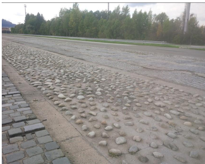
Obr. 31 – Speciální vozovky na zkušebním polygonu TATRA a skladba zkušebního okruhu
