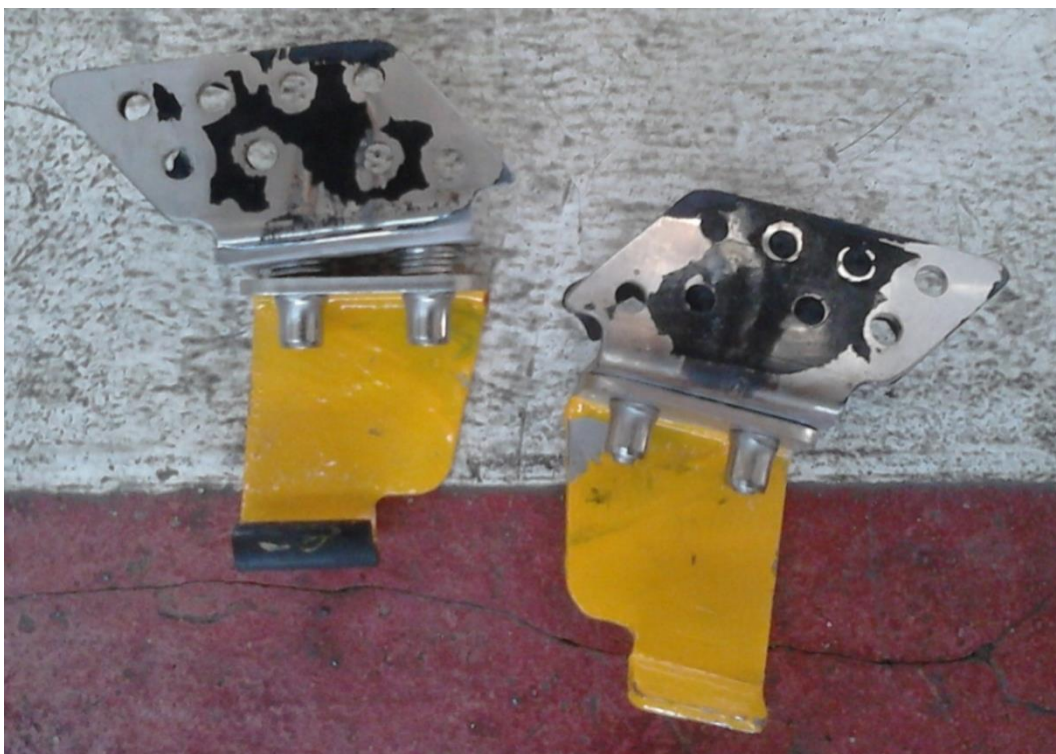
Obrázek 89: Nedostatečné očištění a chemické aktivace v rámci přípravy lepeného povrchu (lepené povrchy by měly být celistvě pokryty soudržným černým povlakem primeru a pozůstatky adhesiva).
