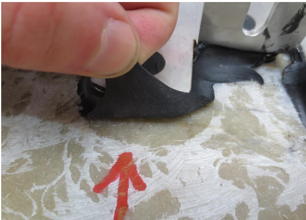
Obrázek 90: Nedostatečné očištění a chemické aktivace v rámci přípravy lepeného povrchu (lepený spoj musí být v celé své ploše k lepenému povrchu adhesně způsobilý).
