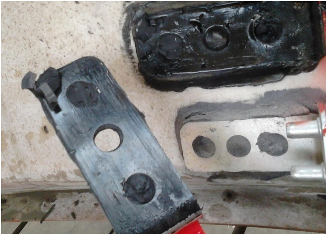
Obrázek 91: Nevhodně provedená příprava lepeného povrchu způsobená nedodržením předepsaných technologických časů - byla překročena buď maximální doba odvětrání naneseného primeru, nebo otevřená doba lepidla (na lepeném povrchu je celistvá černá vrstva primeru bez pozůstatků adhesiva).
