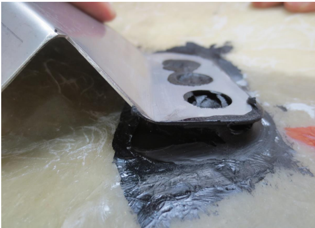
Obrázek 93: Nedostatečná velikost plochy lepeného spoje zapříčiněná kromě nanesení malého množství lepidla i nevhodným umístěním (umístění nanášeného lepidla musí být takové, aby při požadované pozici dílů a přiložení obou lepených povrchů bylo adhesivum vytlačeno po celém svém obvodu mezi lepenými povrchy).
