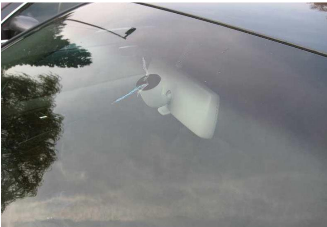
Obrázek 87: Poškození lepeného materiálu způsobené nevhodným konstrukčním návrhem lepeného spoje, kdy bylo použito lepidlo s nízkou elasticitou vzhledem k deformacím lepených materiálů nebo lepidlo, které prostřednictvím exotermní chemické reakce při vytvrzování působilo nadměrným lokálním tepelným namáháním. [4]
