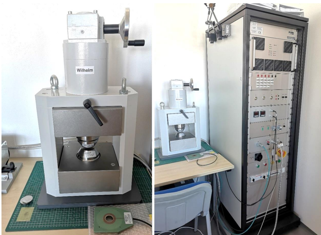
Obr. 10: Hysterezigraf pro měření magnetických vlastností MRE
