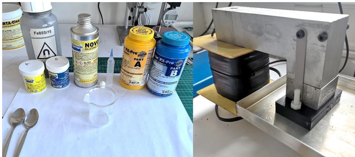
Obr. 14: Příprava před odlitím MRE vzorků v laboratoři (vlevo), tuhnutí vzorku v magnetickém obvodu (vpravo)
