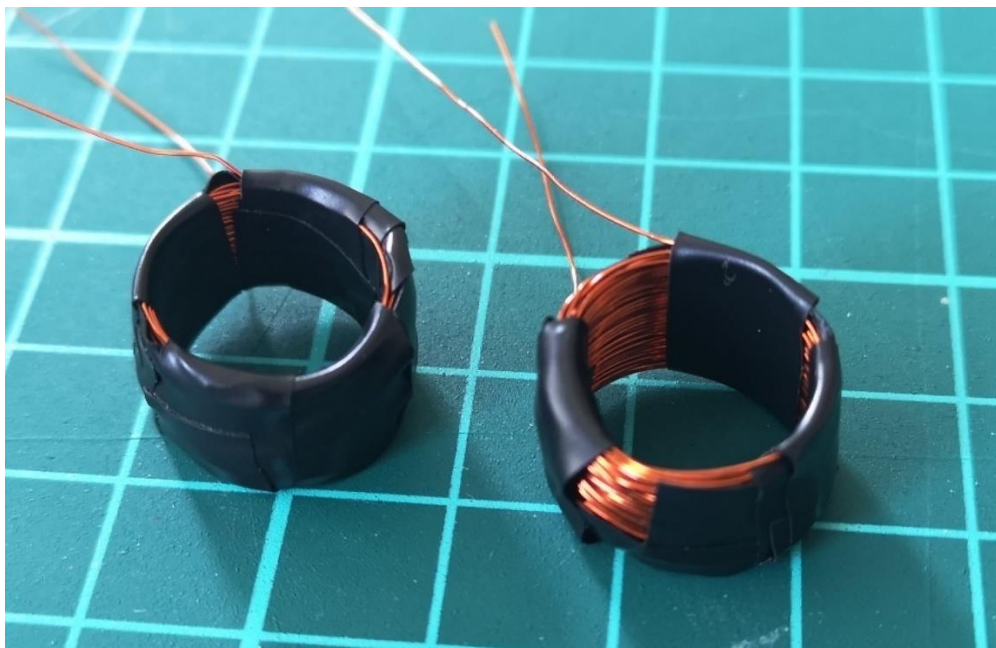
Obr. 52: Cívky primárního a sekundárního vinutí z měděného lakovaného drátu
