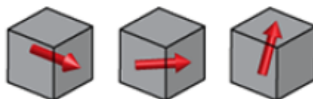
Obr. 7: Voxely s různou orientací magnetických částic [14]
