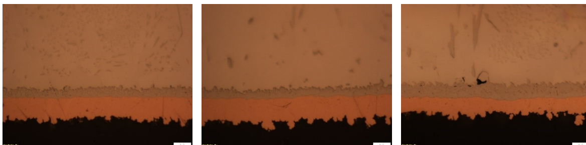
Obr. 50: Snímky struktury pájených spojů SnCu0,2NiCo bez tepelného stárnutí (NA), zleva 1x přetavený, 2x přetavený, 3x přetavený
