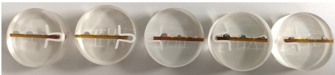
Obr. 12: Materiálografické výbrusy vzorků podrobených zkoušce tepelným zatížením, zleva SnNiGe, SnNiCoP, SAC305, SnCu 0,2 NiGe a SnCu 0,2 NiCo
