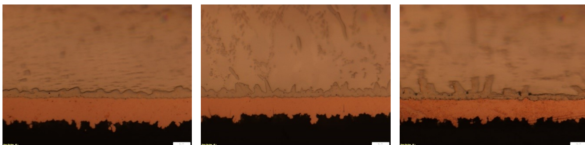
Obr. 46: Snímky struktury pájených spojů SAC305 stárnutých tepelným zatížením (TN), zleva 1x přetavený, 2x přetavený, 3x přetavený
