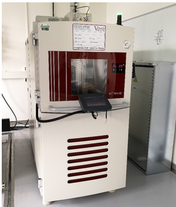
Obr. 7: Šoková teplotní komora Vötsch VT 3 7012 S2
