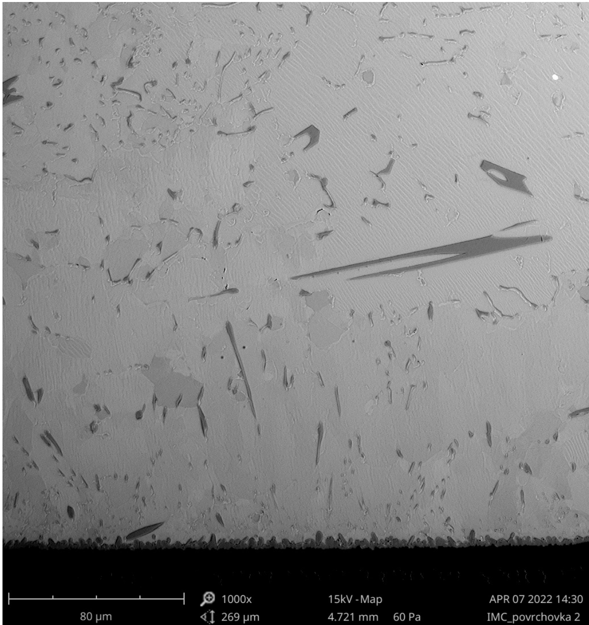
Obr. 54: Struktura pájeného spoje vytvořeného za použití pájecí slitiny SnCu0,2NiGe pořízená elektronovým mikroskopem
