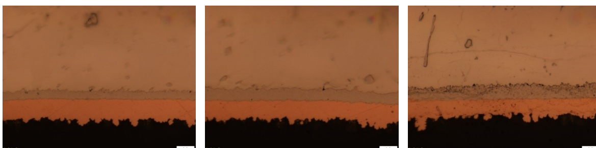
Obr. 51: Snímky struktury pájených spojů SnCu0,2NiCo stárnutých šokovou teplotní zkouškou (Š), zleva 1x přetavený, 2x přetavený, 3x přetavený
