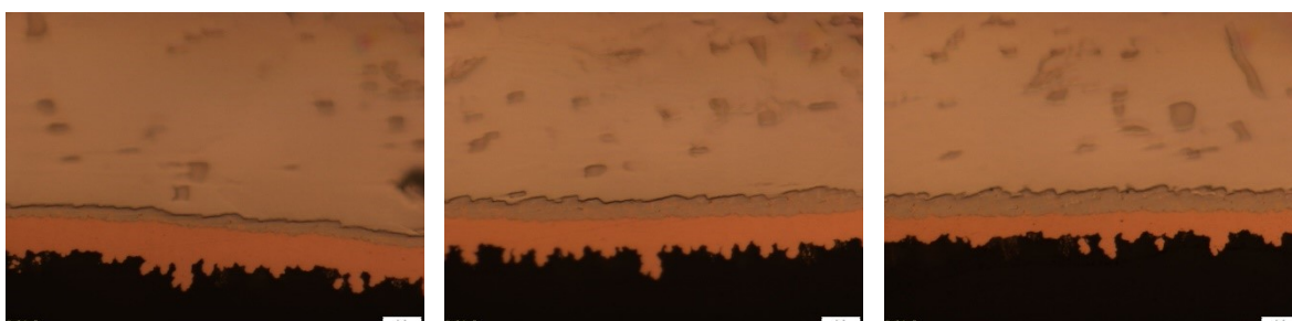
Obr. 39: Snímky struktury pájených spojů SnNiGe stárnutých šokovou teplotní zkouškou (Š), zleva 1x přetavený, 2x přetavený, 3x přetavený
