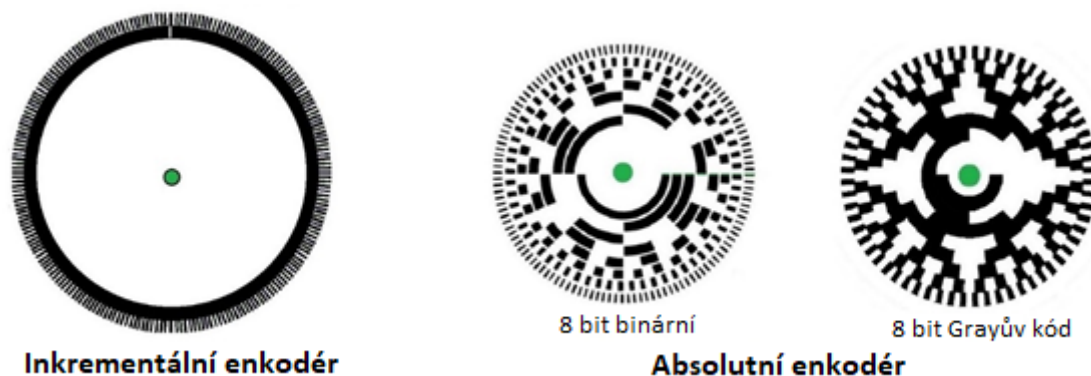
Obrázek 1.11: Disky inkrementálního a absolutního enkodéru (převzato z [15]).
