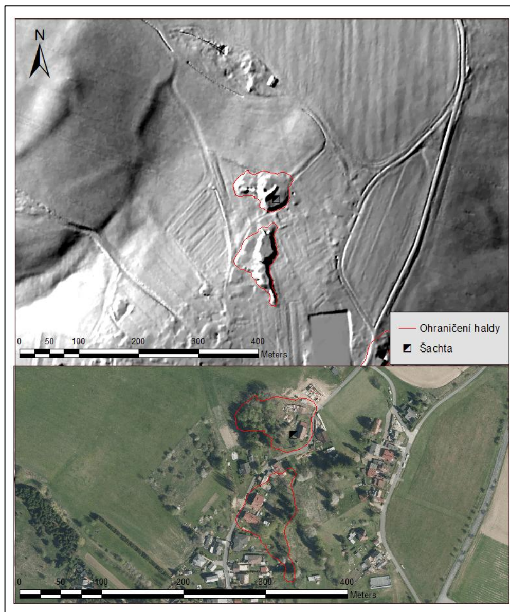
Obrázek 7. Horní obrázek zobrazuje Eliášovu haldu na stínovaném modelu reliéfu krajiny odvozený z dat laserového leteckého snímkování. Spodní obrázek zobrazuje současnou ortofotomapu Eliášovy haldy. 26 Halda je rozdělena cestou na horní severní část a spodní jižní část. Vytvořeno v programu ArcGIS. Úprava Šimon Kouba.
