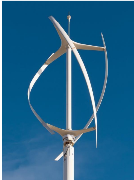
Obr.15 Nakloněné listy Darrieovy turbíny [17]
