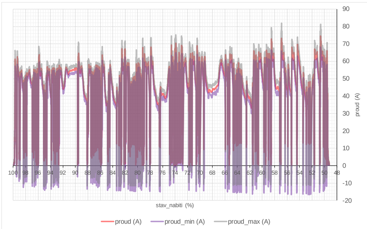
Obr. 48 Vizualizace efektivních hodnot proudu, včetně min. a max. hodnot během měřicí periody
