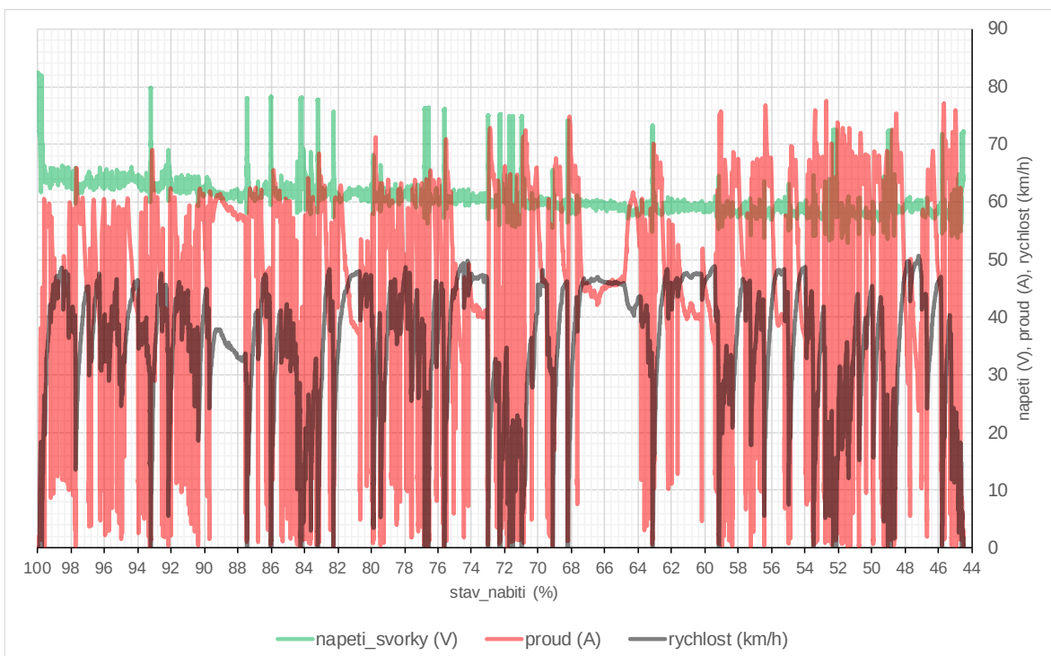
Obr. 38 Vizualizace průběhů napětí, proudu a rychlosti v závislosti na stavu nabití baterie
