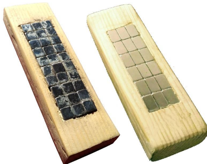
Obr. 29: Prototyp Halbachova (vlevo) a konvenčního uspořádání magnetů (vpravo).
