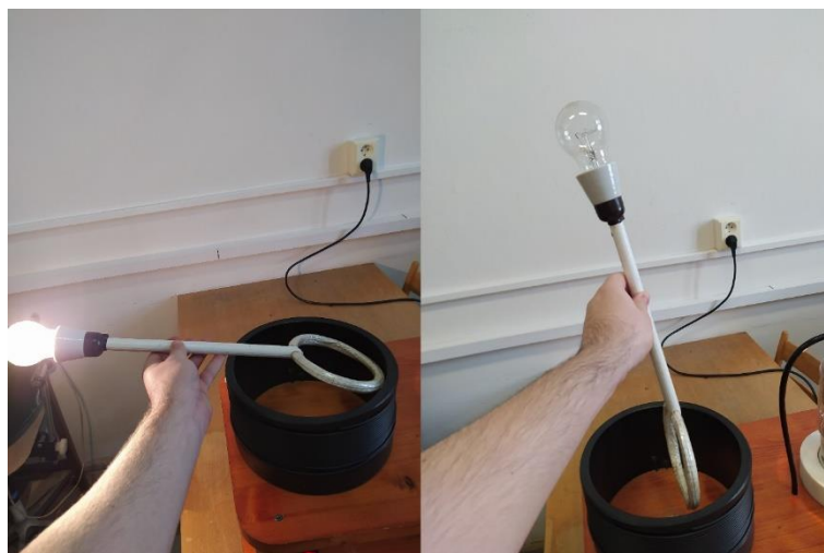
Obrázek 14 - Prezentace magnetické indukce pomocí primární cívky Teslova transformátoru
