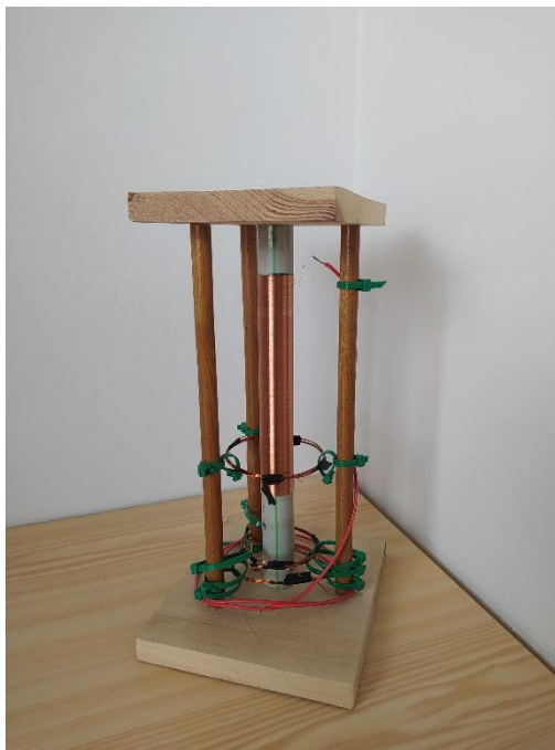
Obrázek 7 - Konstrukce s cívkami pro TC1 a TC2
