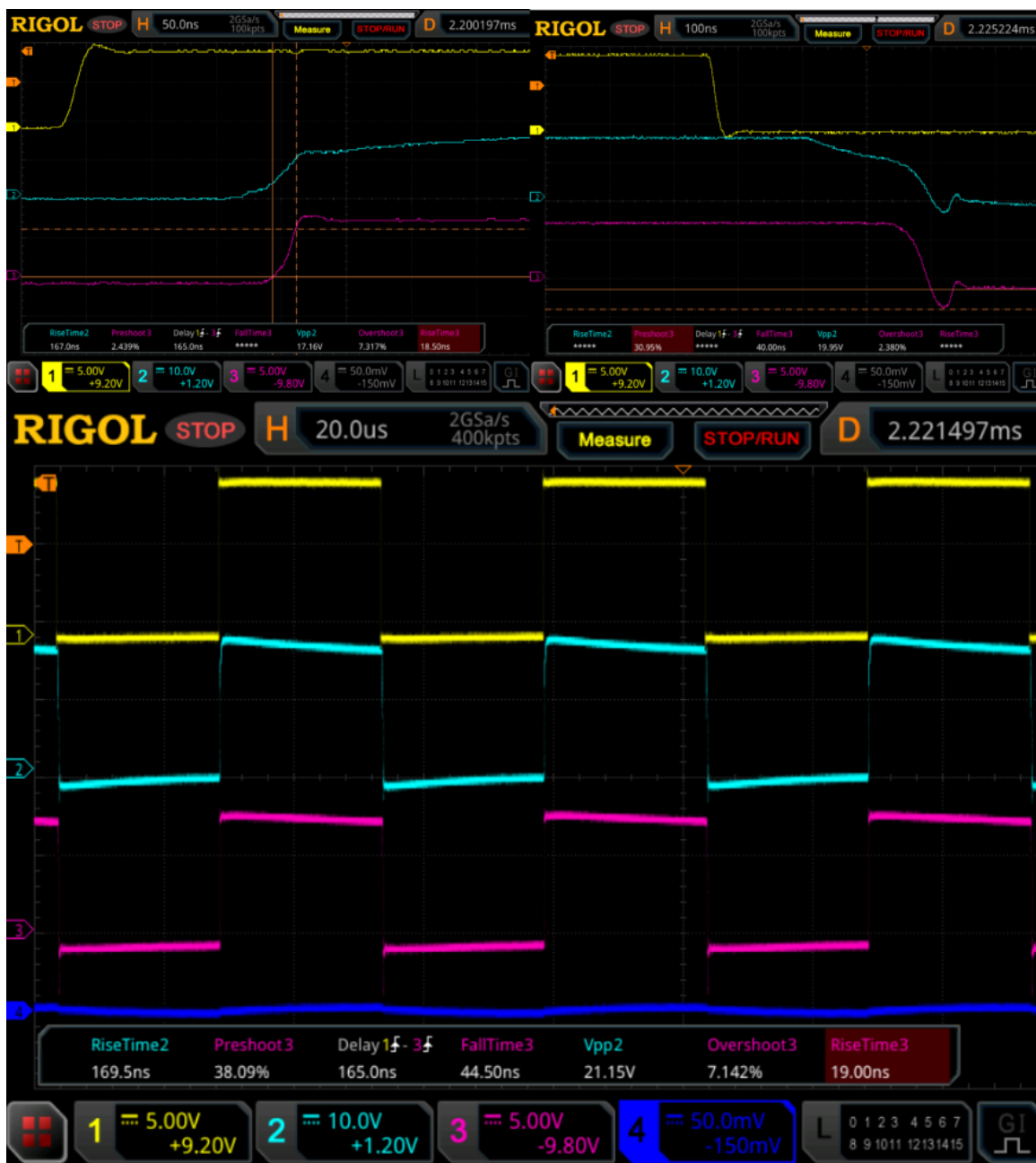
Obr. 58: Měření s upravenými hodnotami R_g . Proud zátěže 15 A, frekvence 20 kHz. Vlevo nahoře je detail náběžné hrany, vpravo nahoře je detail doběžné hrany a dole je zaznamenáno několik period průběhu.
