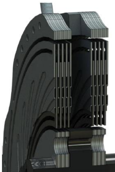
Obr. 1.2: Řez modelem rotačního kondenzátoru [11]
