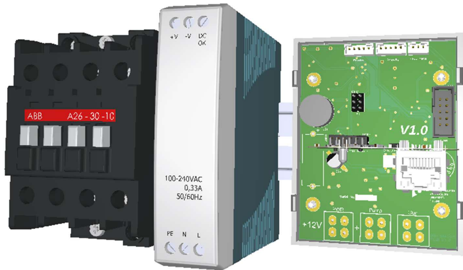
B. 3: 3D náhled din lišty osazené hardwarem pro výdej pohonných hmot, napájecím zdrojem a také stykačem.
