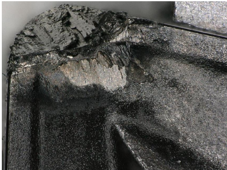
Obrázek 29: Test 2 – destrukce břitu VBD nástroje s vnitřním chlazením po 7. řezu (zvětšeno 100x); foto autor
