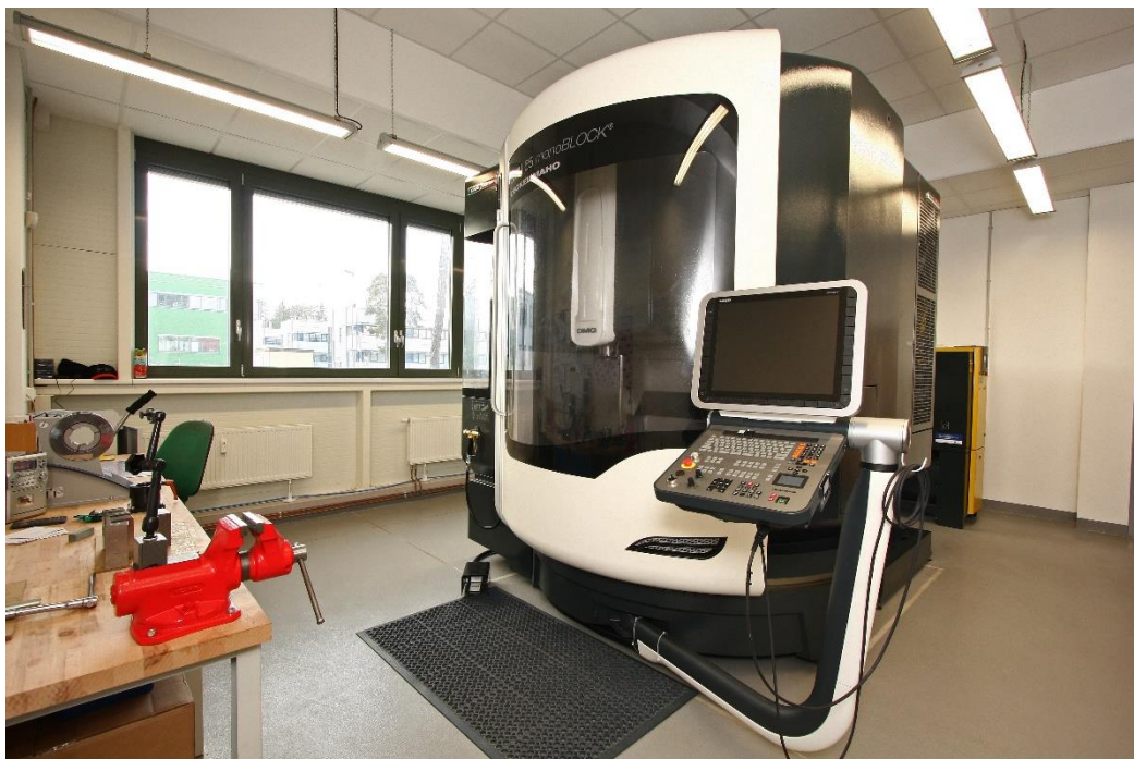
Obr. 54: Obráběcí centrum DMU 65 monoBLOCK – Vědeckotechnický park v Plzni [17]
