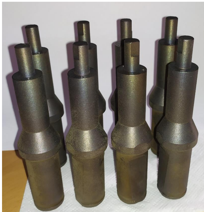
Obr. 50: Vrtáky po tepelném zpracování, připraveny na obrábění
