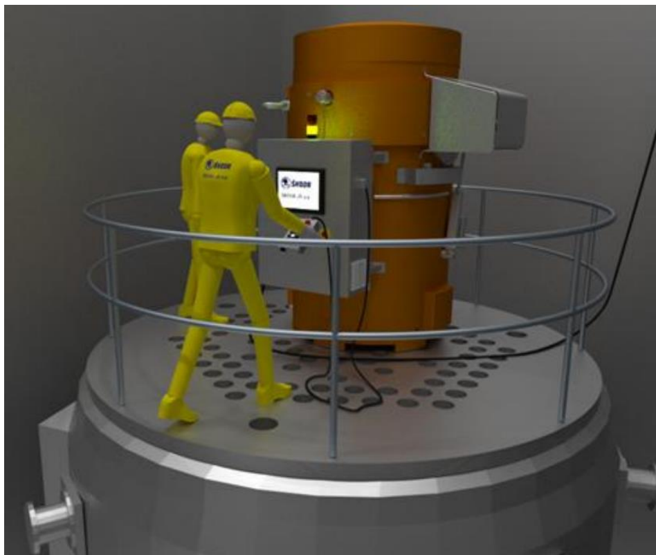
Obrázek 26 - Destrukční modul na principu namotávání čidel (11)
