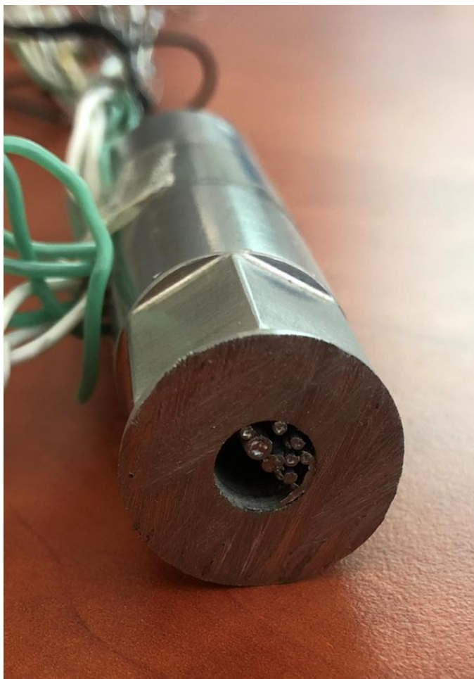
Obrázek 13 - Řez tělesem sondy KNI-LM (6)
