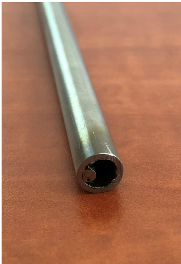
Obrázek 15 - Řez trubicou sondy KNI-LM (6)
