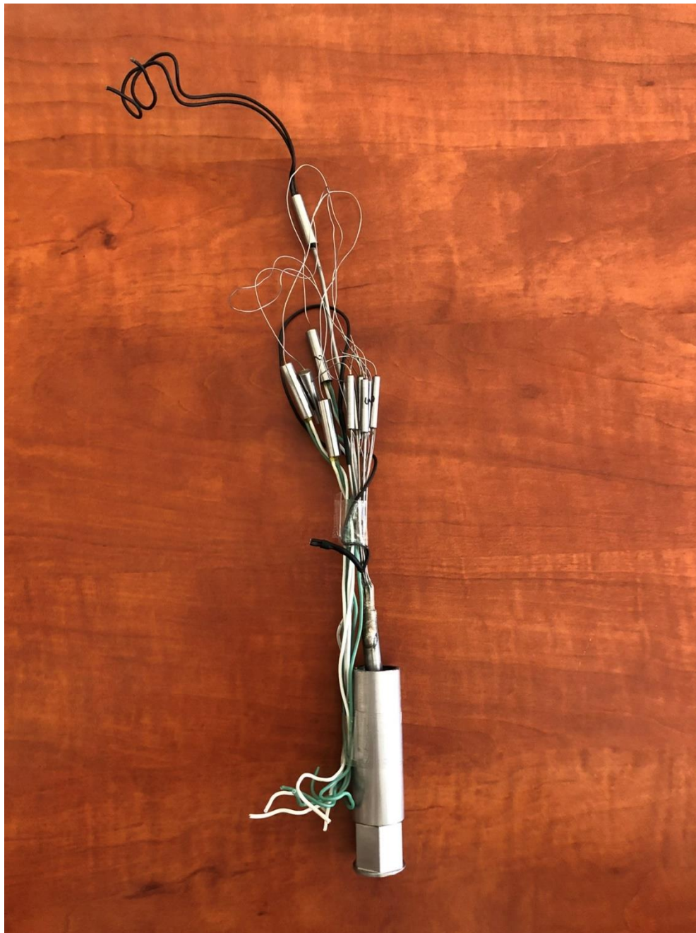
Obrázek 11 - Kabeláž uvnitř pouzdra čidla KNI-LM (6)
