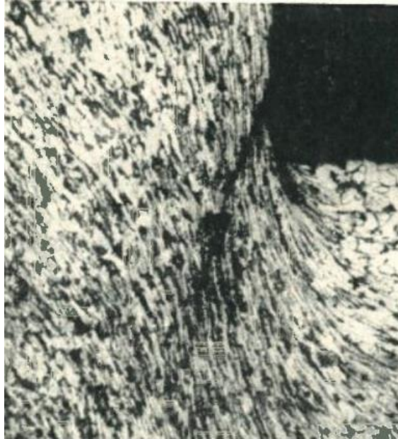
Obrázek 37 - Výbrus tvorby střižné trhliny na břitu nože (12)
