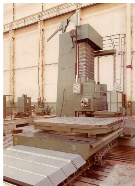
Obrázek 3: Horizontka s CNC obráběním pro firmu Oto Melare
