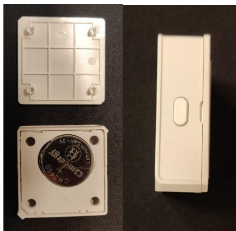
Obr. 22 Otevřený senzor teploty a vlhkosti s párovacím tlačítkem
