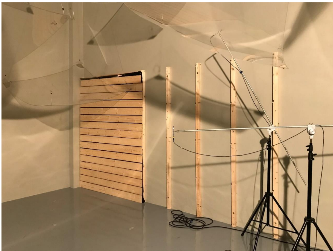
Obr. P3 Laťový rezonátor přimontovaný na stěně dozvukové komory, foceno dne 28. 4. 2022
