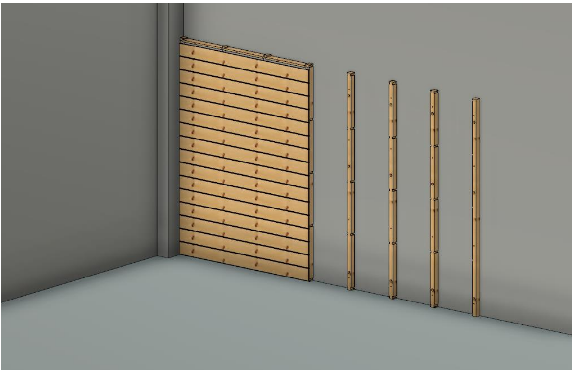
Obr.14 Model laťového rezonátoru, ve svislé konfiguraci na stěně dozvukové komory, vytvořeno v Autodesk Fusion 360
