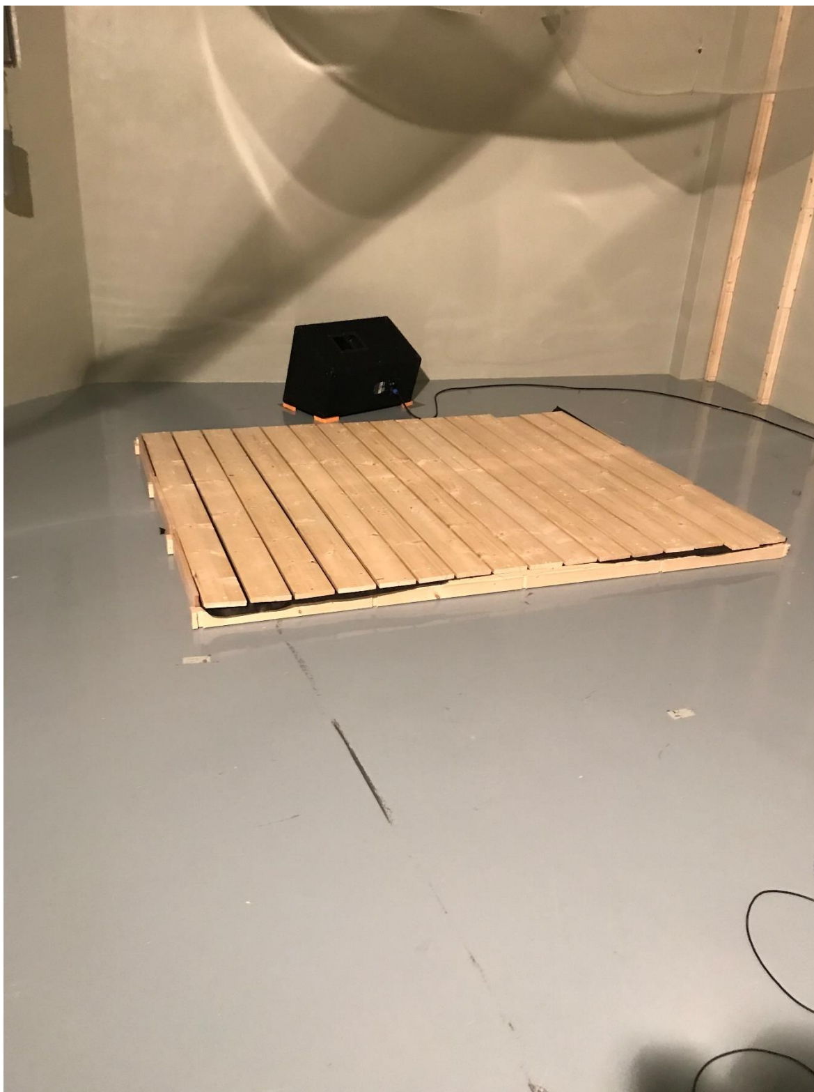
Obr. P5 Laťový rezonátor v konfiguraci na podlaze dozvukové komory, foceno dne 28. 4. 2022
