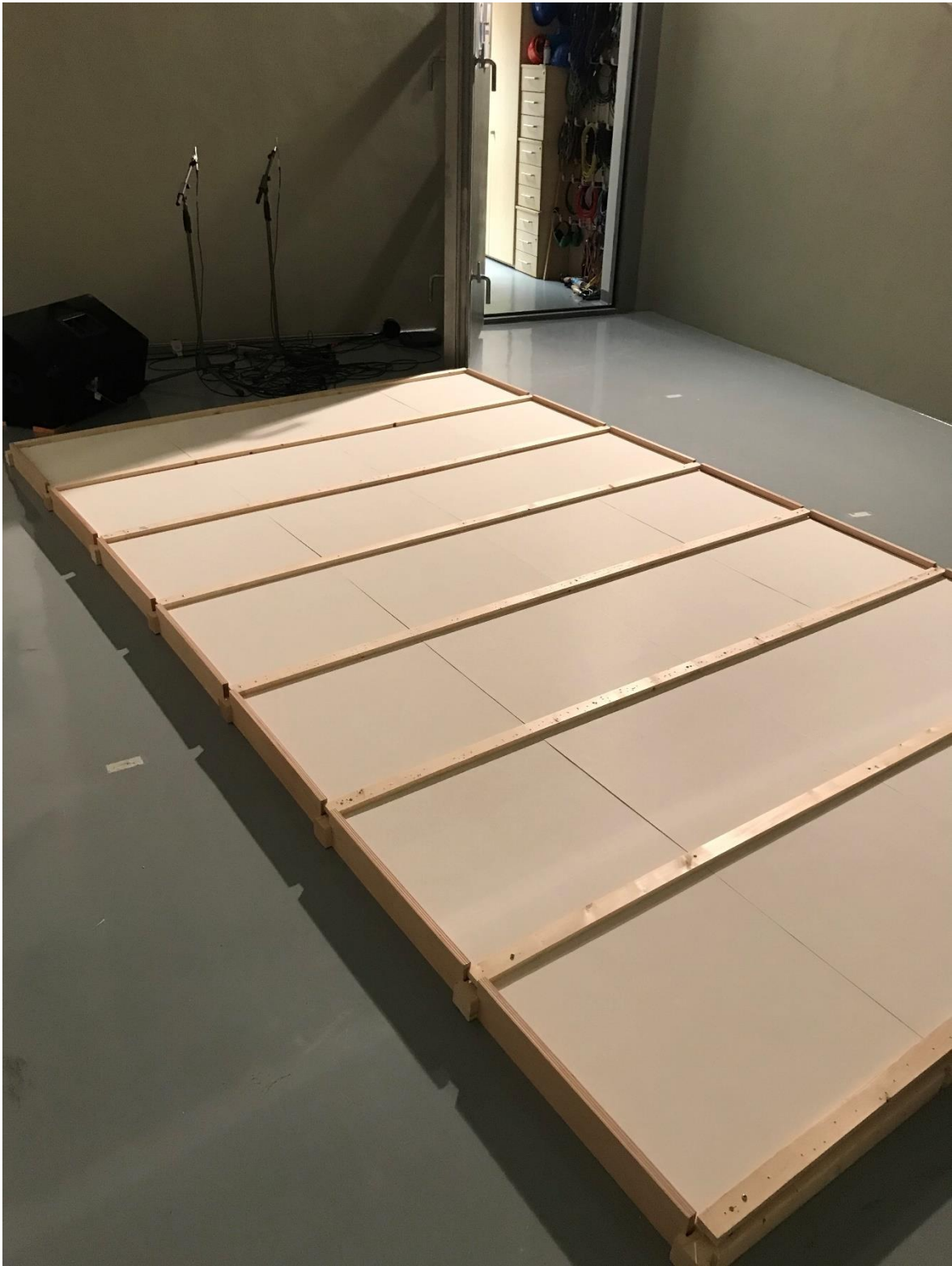
Obr. P6 Obklad z pohledových desek Ecophon OPTA A, na podlaze dozvukové komory, foceno 12. 11. 2021
