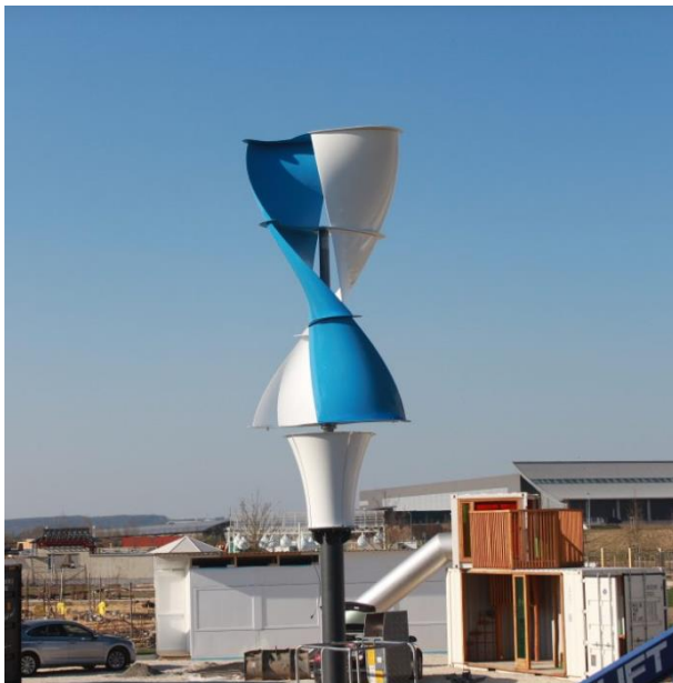
Obr. 3.4 LS SAVONIUS 3.0, odporová turbína se zkroucenými lopatkami [59]
