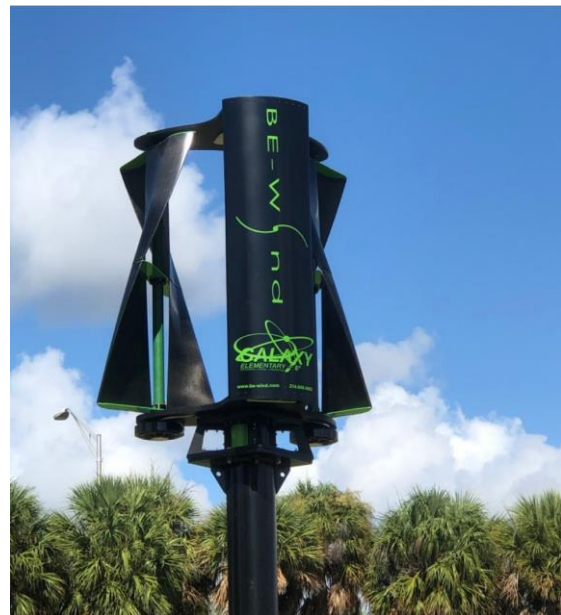
Obr. 3.5 BE-WIND EOW-DUAL, odporová turbína se stíněním [54]
