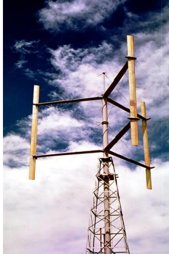
Obr. 3.12 Giromill turbína společnosti McDonnell aircraft, USA [61]
