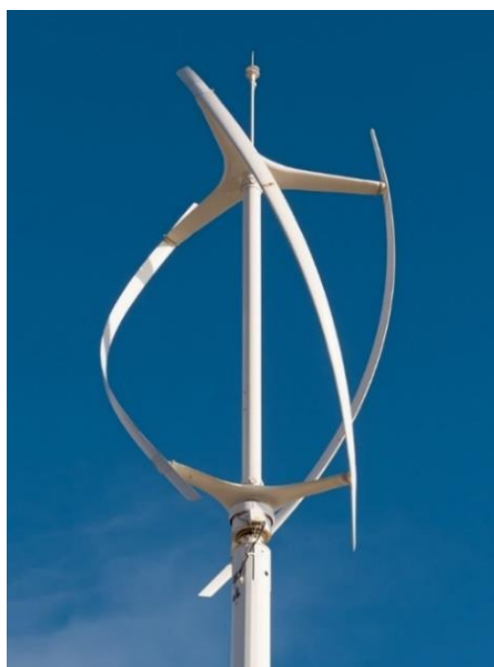
Obr. 3.11 Turbína s lopatkami do spirály [67]
