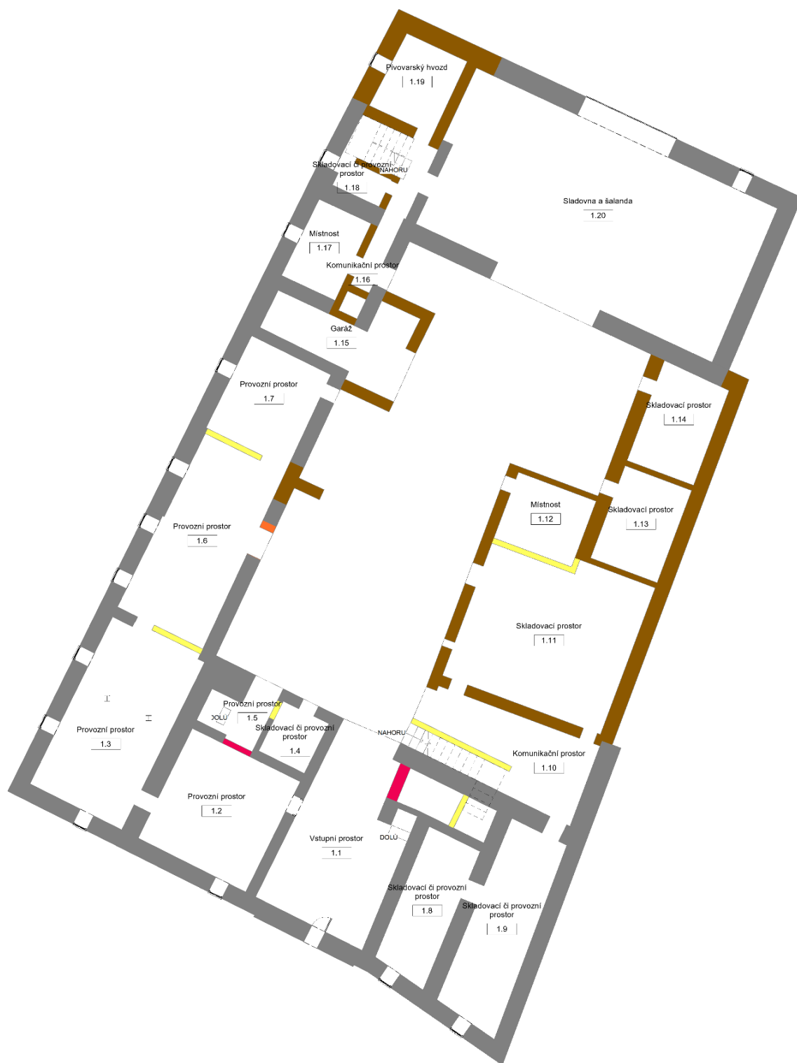
A6: Vizualizace analýzy památkových hodnot pro první nadzemní podlaží vytvořené v softwaru Revit
