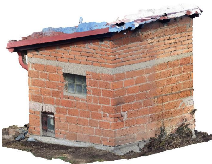
Obr. 10: Virtuální model objektu vytvořený autorkou při využití pozemní fotogrammetrie
