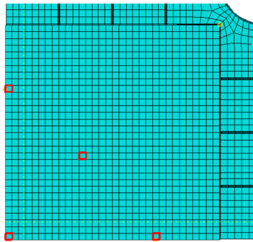
Obr. 16: Detail sítě konečných prvků s vyznačenými elementy pro vyhodnocení sledovaných veličin
