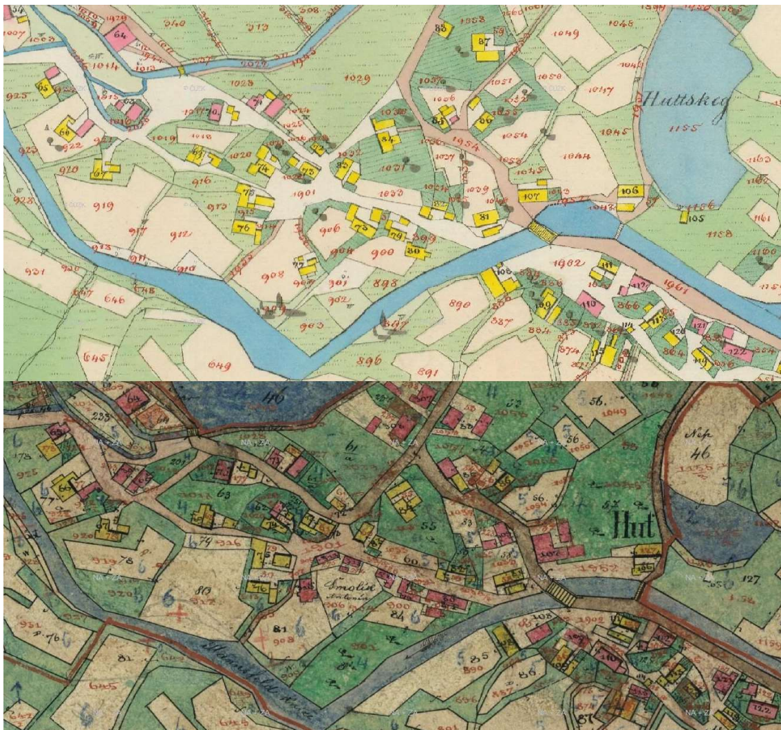
Obrázek 4: Náhled dokumentace ÚAZK – stejné území na císařských povinných otiscích SK (nahore) a indikačních skicách (dole) [33]
