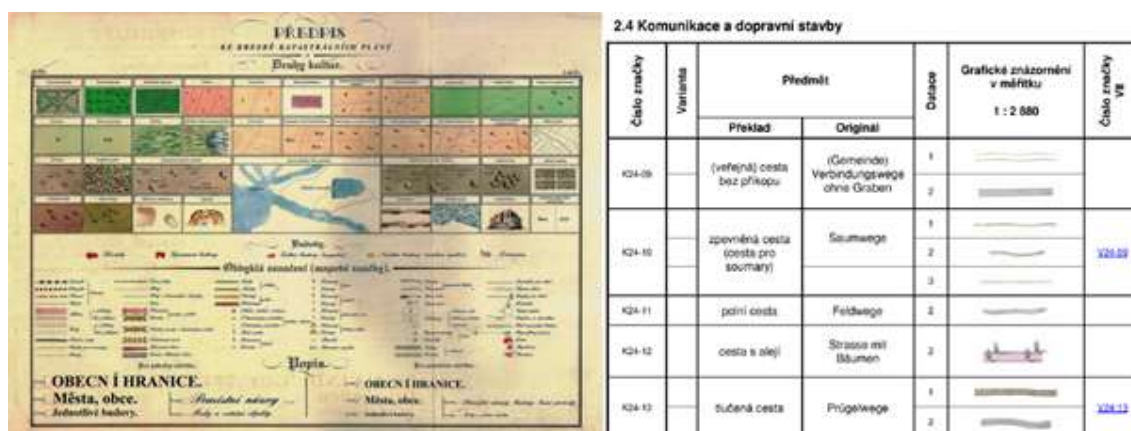
Obrázek 5: Podklady pro rozeznání mapových znaků – značkový klíč (vlevo) a katalog objektů SK (vpravo) [41, 42]
