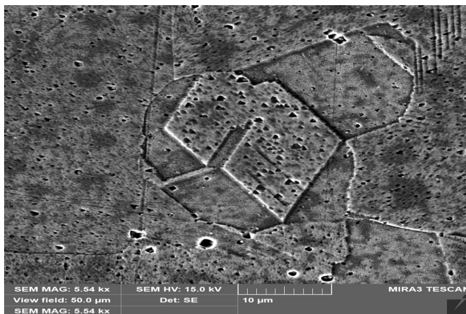
Obrázek 8: Vyhodnocení lomové plochy vzorku po tepelném zpracování při teplotě TZ 1 ..... s. 92
