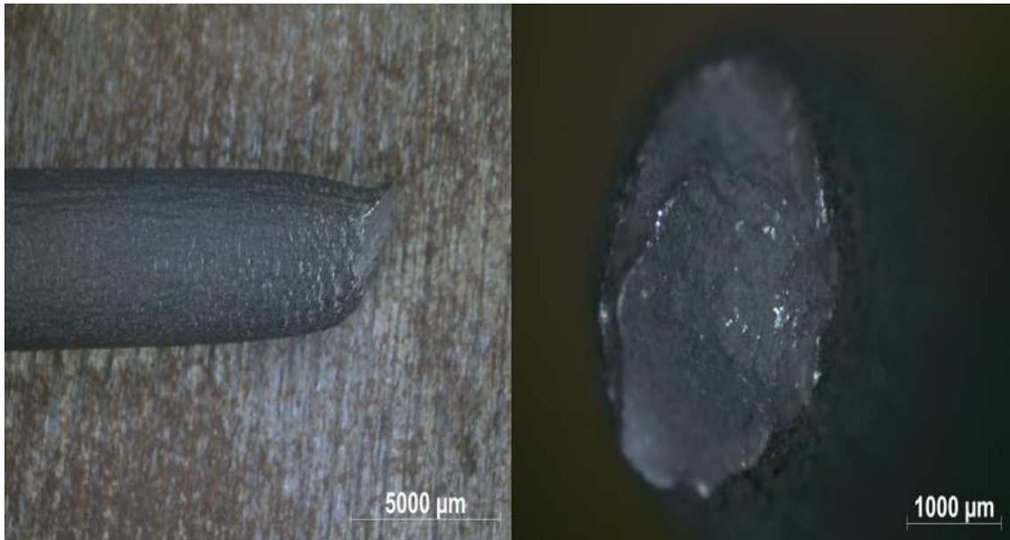
Obrázek 12: Vyhodnocení lomové plochy vzorku po HIP s následným tepelným zpracováním při teplotě TZ 2..... s. 94
