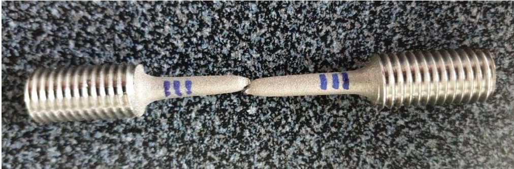
Obr. 20: Zkušební vzorek z oceli AISI 316L po tahové zkoušce
