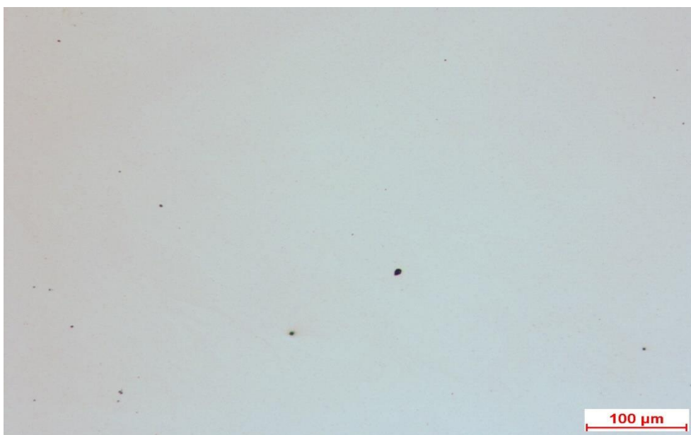
Obr. 29: Ukázka pórovitost vzorku po tepelném zpracování při teplotě TZ 2
