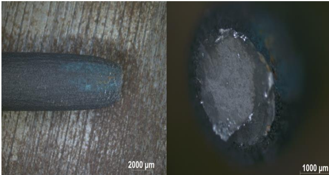
Obrázek 10: Vyhodnocení lomové plochy vzorku po HIP..... s. 93
