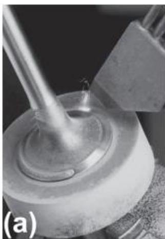
Obr. 13: (a) Laserové navařování čela sedla ventilu, (b) laserová depozice jako náhrada za vložky ventilových sedel[3]
