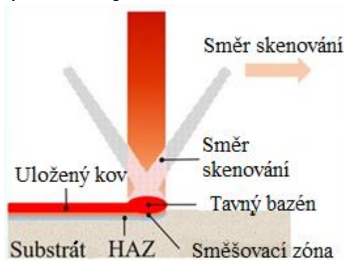
Obr. 4: Schéma extrémně rychlého laserového navařování[11]
