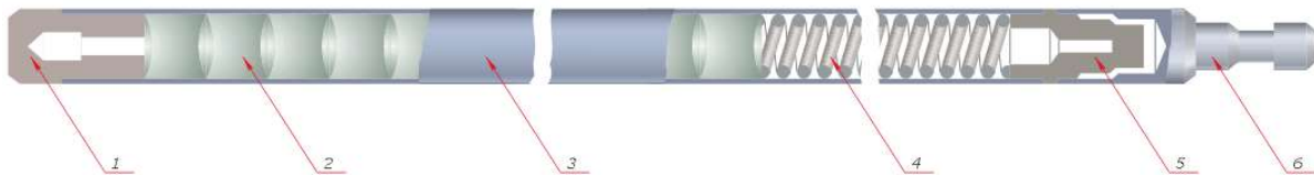
Obr. 9: Uspořádání palivového článku reaktoru RBMK: 1 - zástrčka; 2 - tablety oxidu uraničitého; 3 – povlaková trubka; 4 - pružina; 5 - pouzdro; 6 – špička [17].
