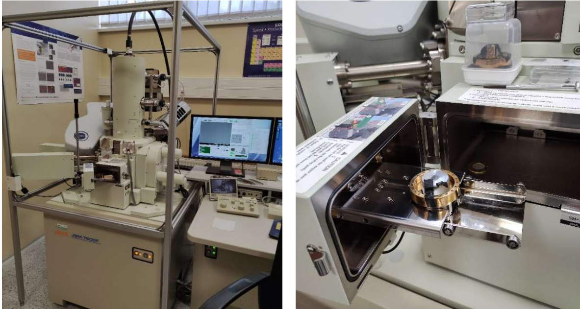
Obr. 15: JSM-7600F Schottky Field Emission SEM v NTC ZČU (zleva) a proces zakládání vzorku do uzavírací komory (zprava).
