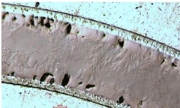
Obr. 31: Výsek prstence vzorku č. 2 (vlevo) a oxidická vrstva ZrO_2 (vpravo)
