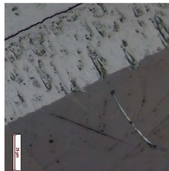
Obr. 31: Výsek prstence vzorku č. 2 (vlevo) a oxidická vrstva ZrO_2 (vpravo)
