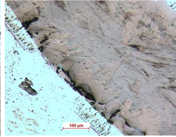
Obr. 33 Odlupování vnější vrstvy ZrO 2
