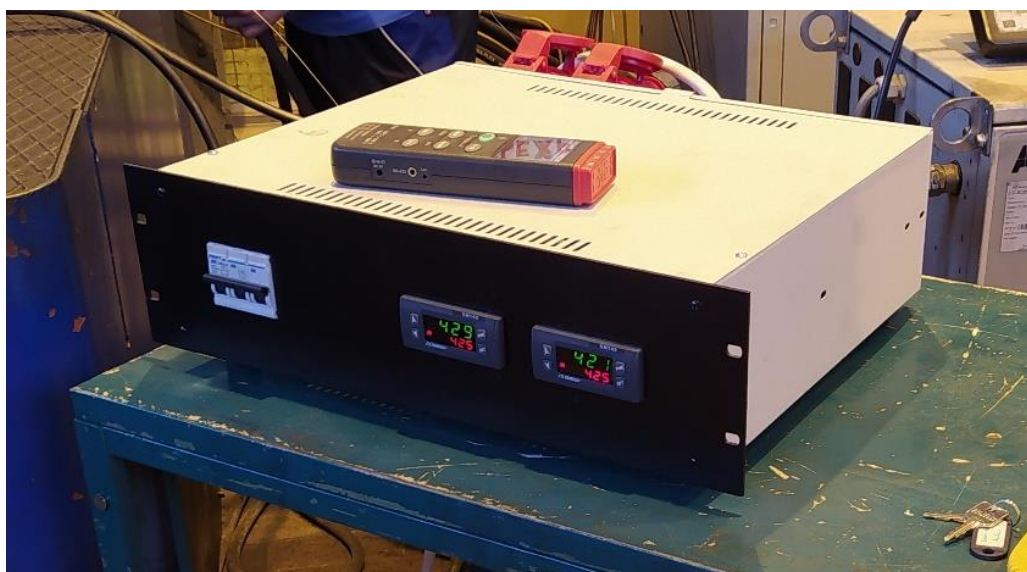
Obr. 10-3: Zdroj s PID regulátory použitý pro ohřev topných patron v nástroji
