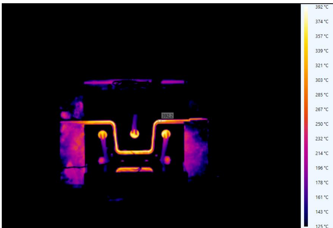
Obr. 10-2: Záznam nábřevu nástroje z termokamery
