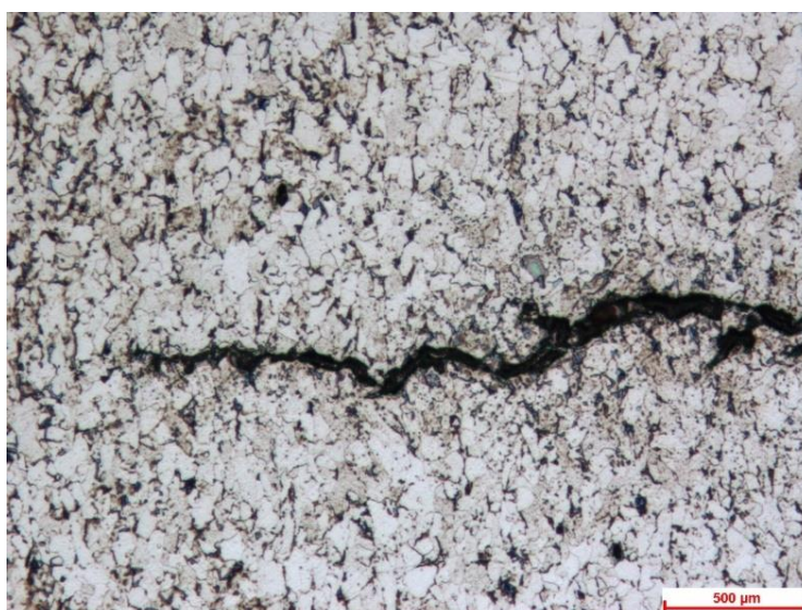
Obr. 63 - S460MC HFMI, plastická oblast trhliny (světelný mikroskop) (střed zkušebního tělesa, zkouška č. 5 viz. Tab. 8)
