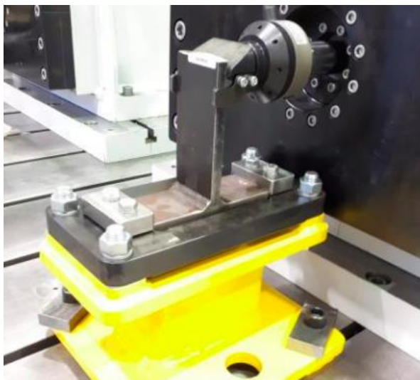
Obr. 39 – Uchycení zkušebního tělesa na standu pro zkoušky konstrukčních uzlů s koutovými svary [37]
