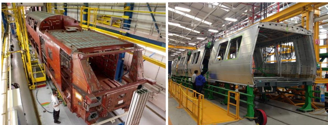
Obr. 17 - Skříň vozidla Bombardier Regio 2N (vlevo) a BART (vpravo) [44; 45]
