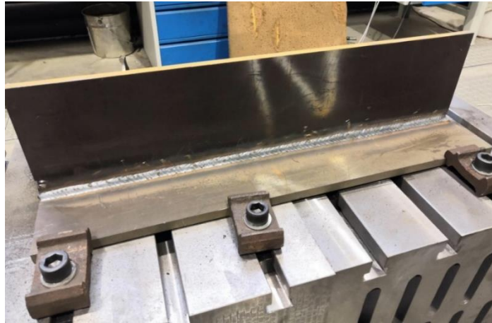
Obr. 24 - Konečný tvar svařence před rozřezáním na zkušební tělesa
