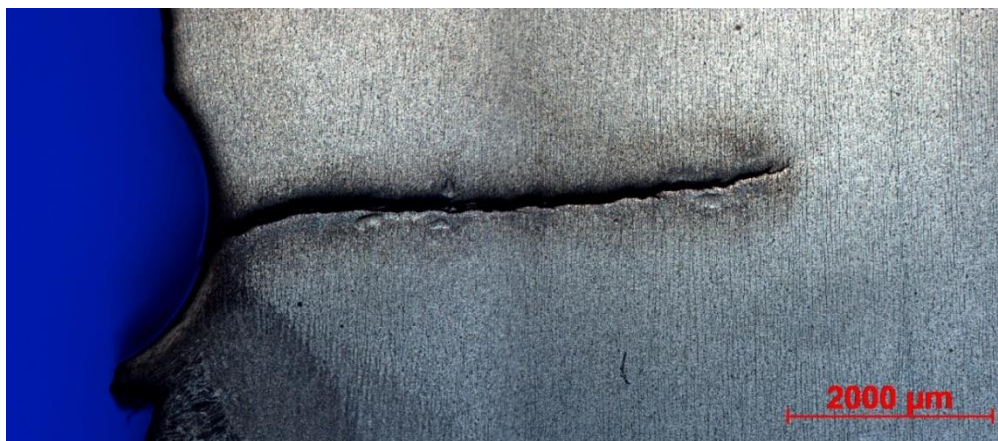
Obr. 50 - Výbrus S235JR s aplikací HFMI, trhlina (střed zkušebního tělesa, zkouška č. 1 viz. Tab. 7)
