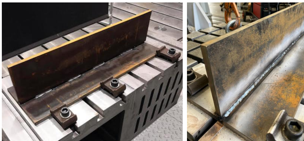
Obr. 23 – Kořenová vrstva svaru, přerušované svary (vlevo) a souvislý svar (vpravo)
