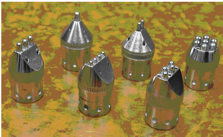
Obr. 10 - Různé typy a konfigurace indentorů [41]
