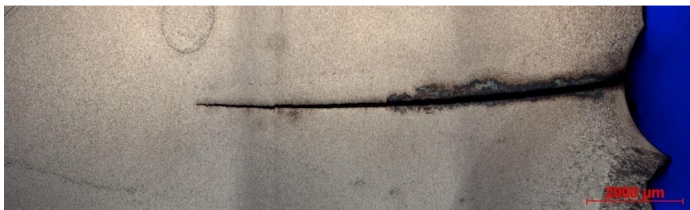
Obr. 60 - Výbrus S460MC s aplikací HFMI, trhlina; (střed zkušebního tělesa, zkouška č. 5 viz. Tab. 8)
