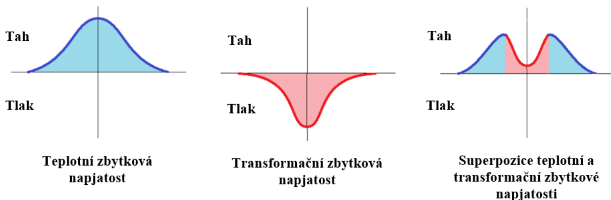
Obr. 20 - Průběhy teplotní a transformační napjatosti [30]
