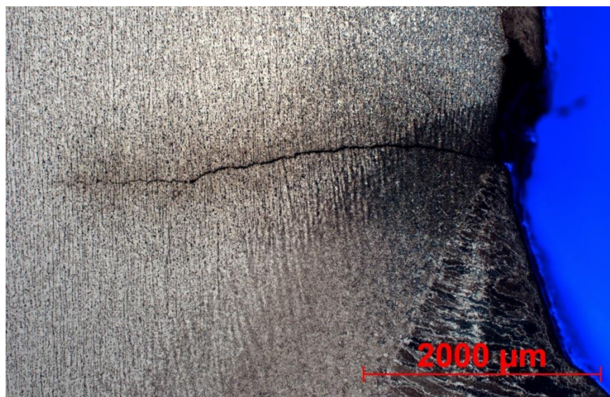
Obr. 46 - Výbrus S235JR bez HFMI, trhlinka (střed zkušebního tělesa, zkouška č. 1 viz. Tab. 7)
