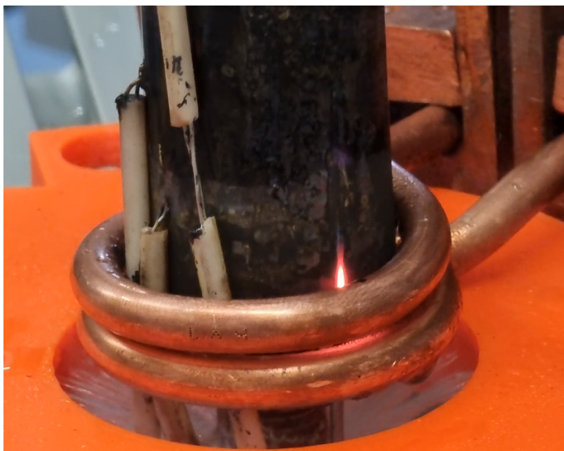
Obrázek 17: Vliv termočlánku umístěného těsně pod povrchem vsázky, ocel EN C35
