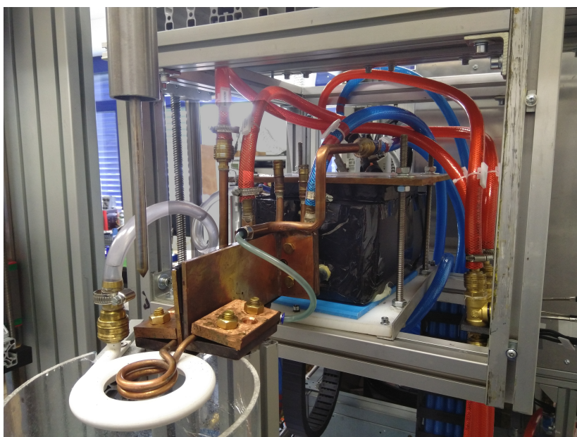
Obrázek 14: Připevnění induktoru průměru 33 mm s kalící sprchou k vysokofrekvenčnímu transformátoru
