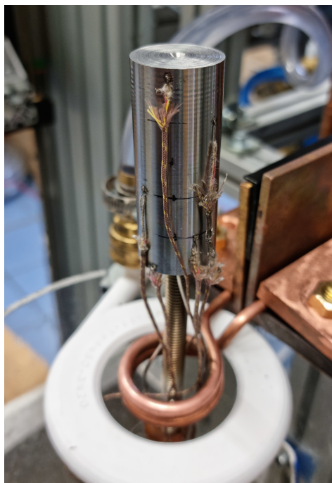
Obrázek 19: Ocelová vsázka před a po zakalení
