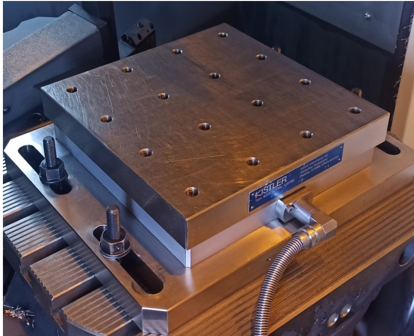
Obr. 26: Obrobkový dynamometr Kistler 9255C [autor]
