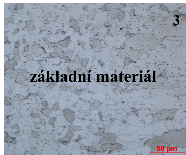
Obr. 23 - Mikrostruktura 5. spoje základního materiálu
