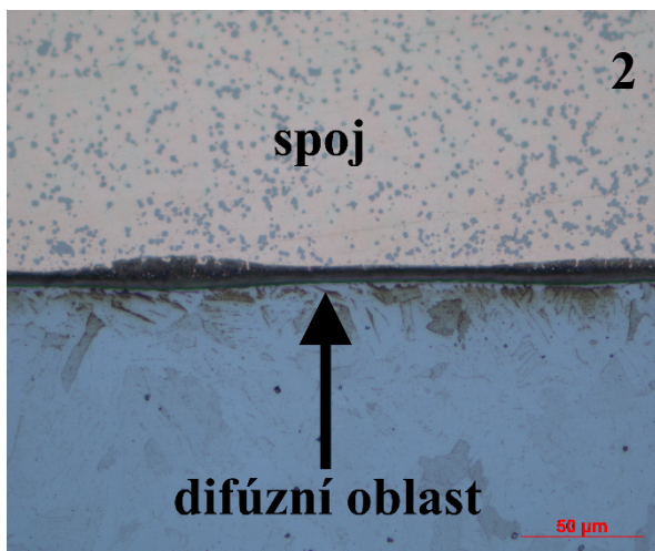
Obr. 26 - Mikrostruktura 7. spoje přechod spoje a difúzní oblasti
