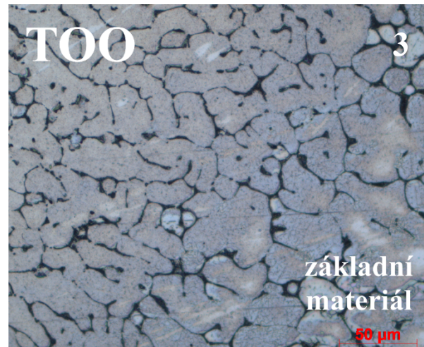
Obr. 31 - Mikrostruktura 9. svaru přechod TOO a základního materiálu
