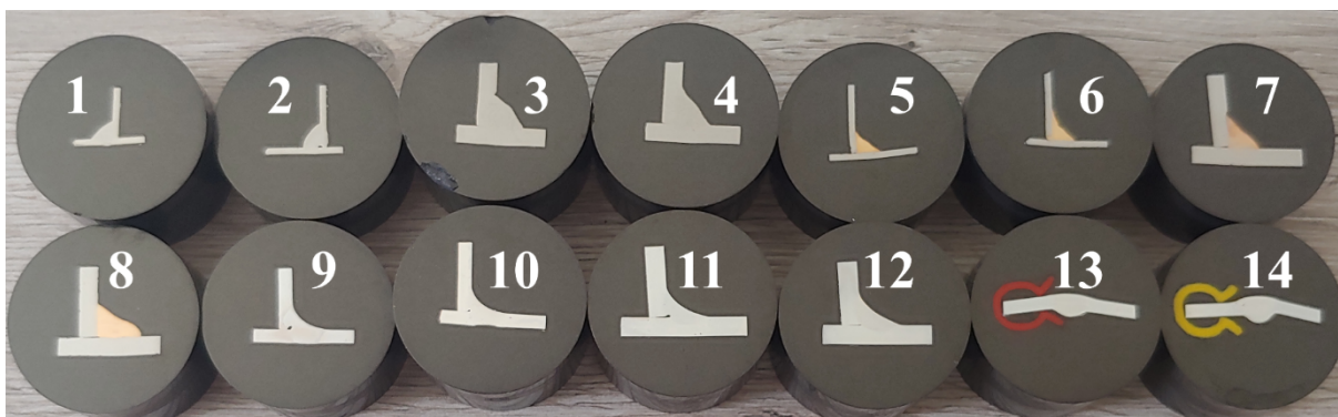
Obr. 11 - Zhotovené metalografické vzorky
