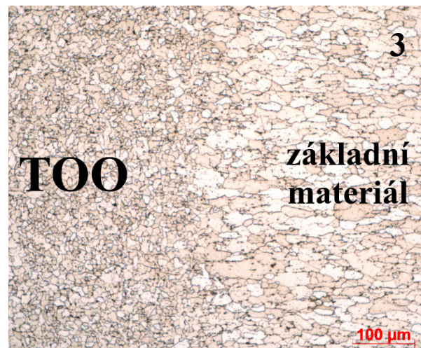
Obr. 15 - Mikrostruktura 1. svaru přechod TOO a základního materiálu
