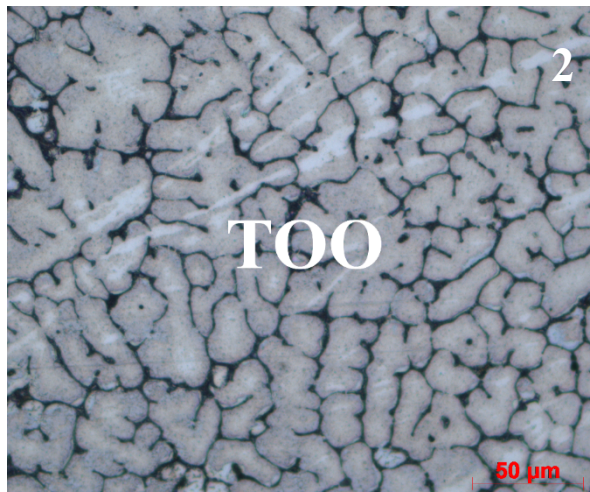
Obr. 30 - Mikrostruktura 9. svaru v TOO
