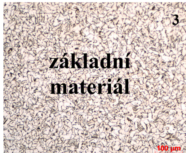
Obr. 19 - Mikrostruktura 3. svaru základního materiálu
