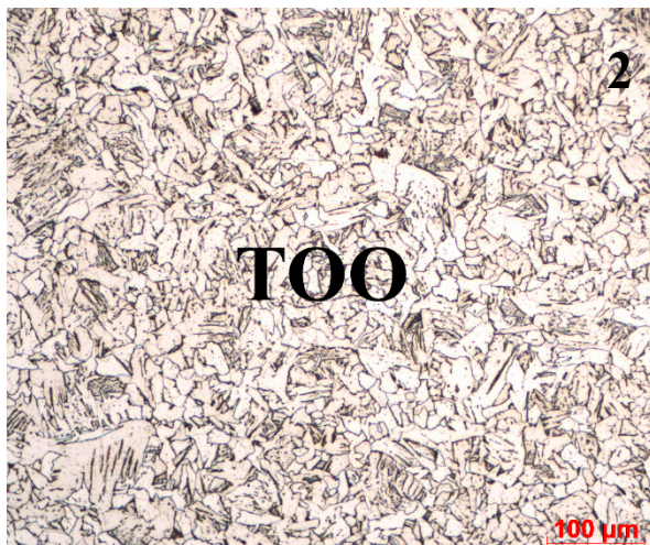
Obr. 18 - Mikrostruktura 3. svaru v TOO
