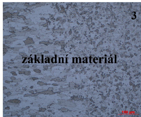
Obr. 27 - Mikrostruktura 7. spoje základního materiálu
