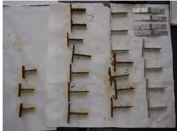
Obr. 44 - Vzorky vyndané z korozní komory
