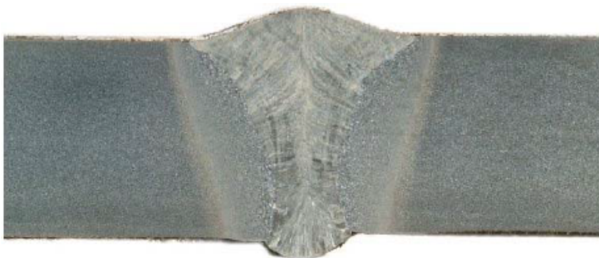
Obr. 6 - Ukázka svaru do zúženého místa při použití WiseFusion™ [3]
