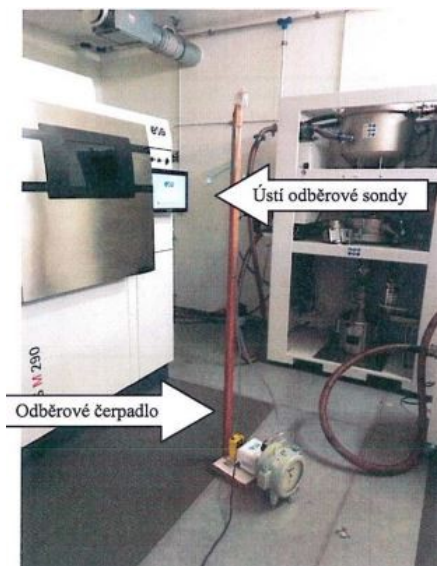
Obrázek 24: Druhé odběrové zařízení ve středu místnosti (5p)
