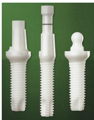
Obrázek 1 Dentální implantáty z polykrystalické aluminu [8]
