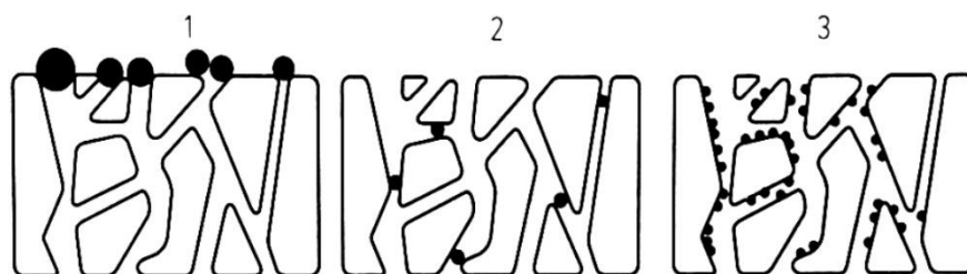
Obrázek 5 Schéma zachycování kalových částic na filtrační přepážce 2
