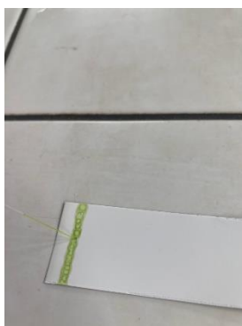
Obrázek 55: nanášení filtrátu na chromatografickou desku
