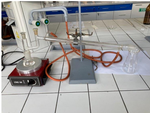
Obrázek 41: destilační aparatura (destilace extraktu betulin-diacetátu)
