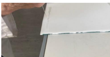
Obrázek 33: nanášení směsi pomocí balónku na chromatografickou desku
