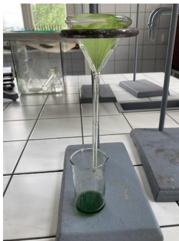
Obrázek 54: filtrace směsi barviv z jehličí v acetonu
