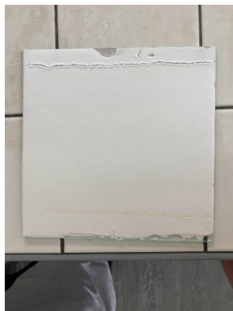
Obrázek 36: preparativní TLC po vyjmutí z chromatografické komory (označeno čelo a start)
