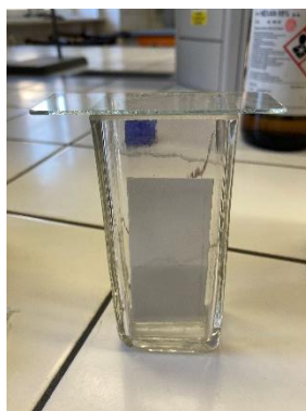
Obrázek 29: vývojová komora s chromatografickou deskou a nanesenými vzorky a standardem.
