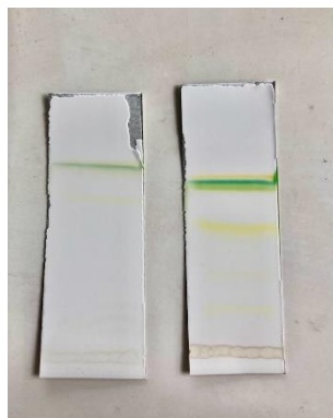
Obrázek 61: porovnání TLC jehličí a TLC listí (vlevo jehličí, vpravo listí)
