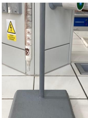
Obrázek 40: trubice s vatou a směsí z preparativní chromatografie betulín-diacetátu
