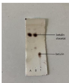
Obrázek 30: chromatografická deska s nanesenými standardem a vzorky – A: vzorek A, B: vzorek B, 1: čistý betulin
