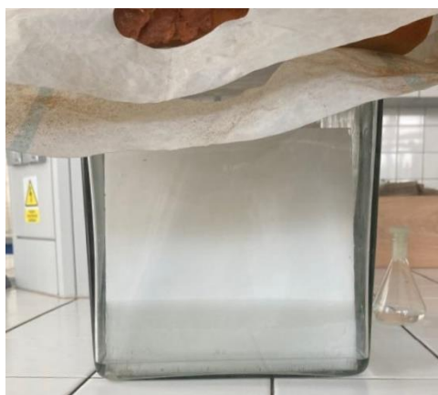
Obrázek 34: chromatografická deska v chromatografické komoře se směsí rozpouštědel
