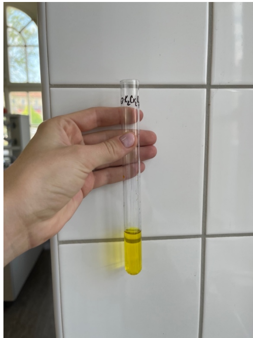
Obr. 16 Žlutý roztok chromanu draselného. Vzniká přidáním hydroxidu draselného.
