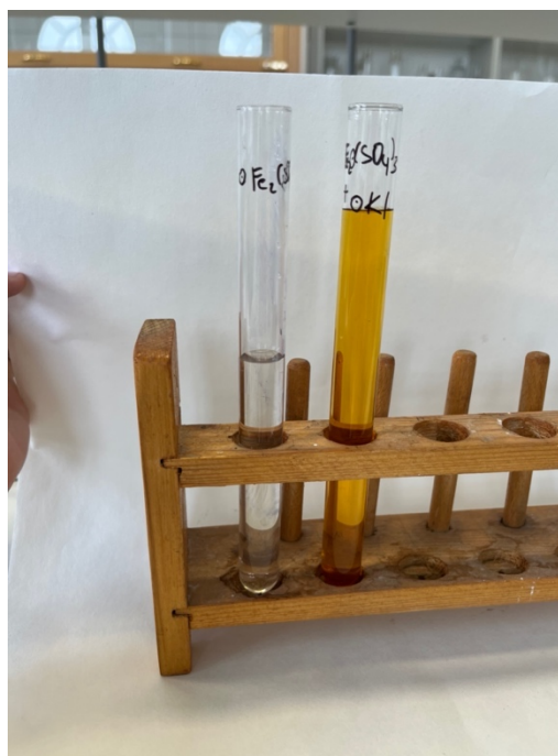
Obr. 25 Oxidací jodidových aniontů vzniká jód a bezbarvý roztok se mění v červenohnědý.
