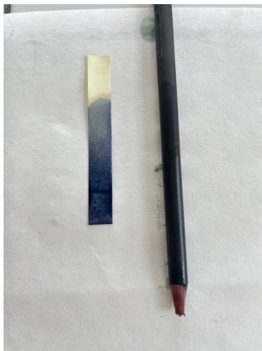
Obr. 36 Výsledky elektrolýzy. Na katodě vznikl povlak červenohnědé mědi, na anodě jsme pomocí navlhčeného jodoškrobového papírku dokázali vznik chloru.
