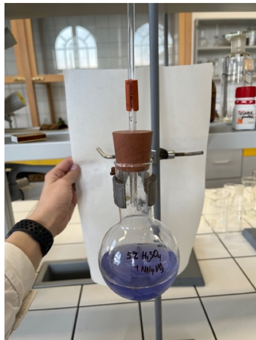
Obr. 8 Baňka s fialovým roztokem síranu vanadnatého uzavřená Bunsenovým ventilem.
