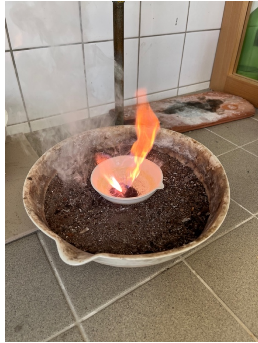
Obr. 22 Vznícení manganistanu. Lze pozorovat slabě fialový plamen, typický pro draselné kationty.
