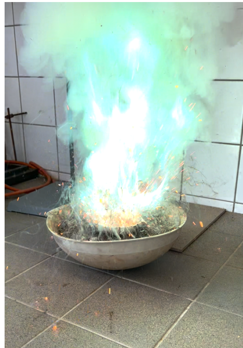
Obr. 48 Vzplanutí směsi světle modrým plamenem – silně exotermická reakce.
