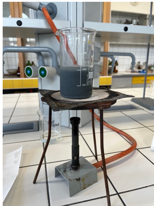
Obr. 42 Zahřívání měděného plíšku ve směsi zinku a hydroxidu sodného.
