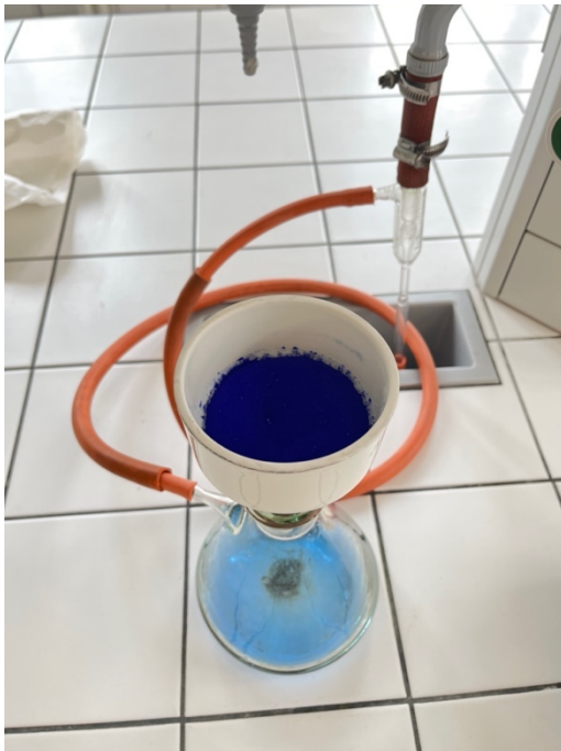
Obr. 39 Odfiltrování vzniklé sraženiny na Büchnerově nálevce.
