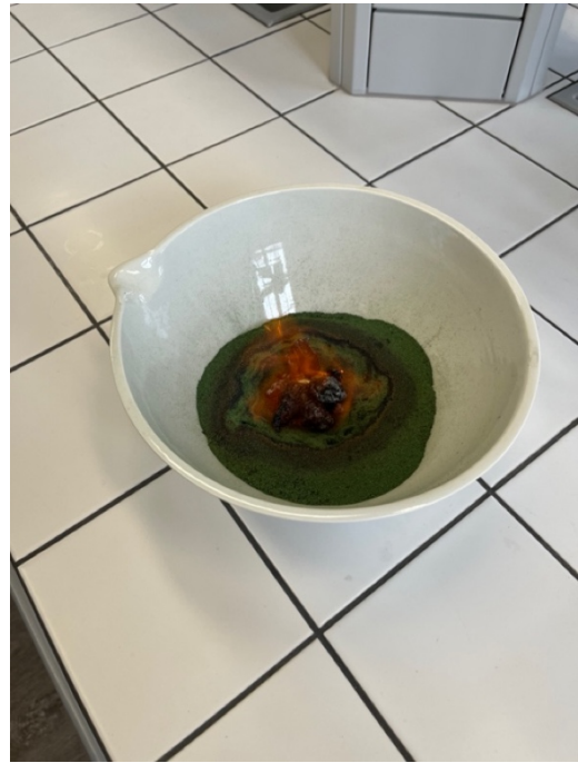
Obr. 13 Zapálení ethanolem navlhčeného oxidu chromitého, začátek růstu hada.
