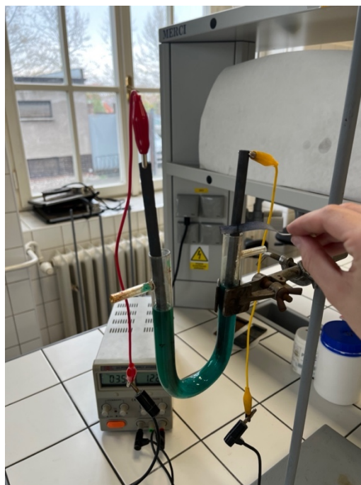
Obr. 35 Průběh elektrolýzy, dokazování vznikajícího chloru na anodě.
