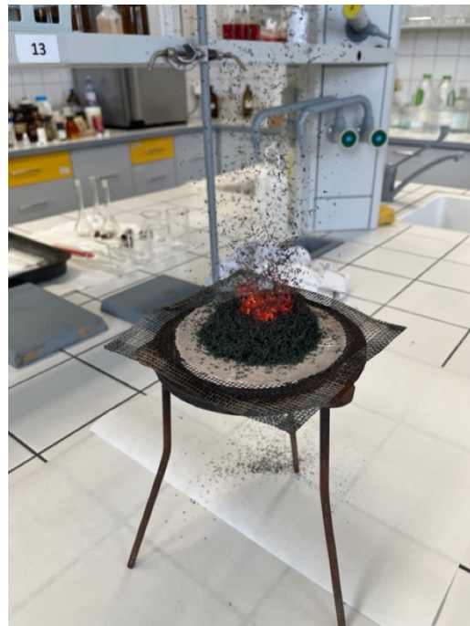
Obr. 10 Vznikající tmavě zelený oxid chromitý nadnášený dusíkem a vodní párou.
