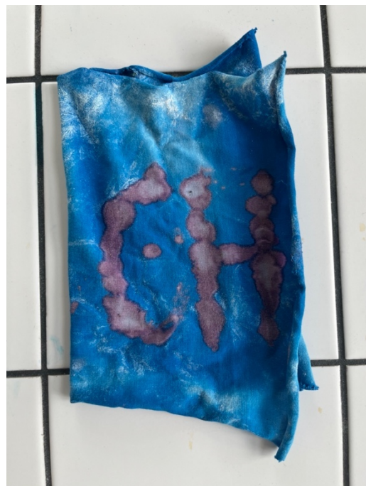
Obr. 32 Usušený hadřík pokapaný vodou. Změna zbarvení modrého bezvodého chloridu kobaltnatého v růžovofialový hydratovaný chlorid kobaltnatý.
