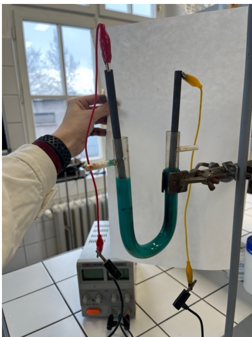
Obr. 34 Příprava aparatury s elektrodami a roztokem chloridu měďnatého.
