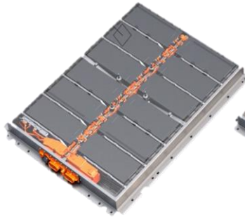
Obr. 55 Škoda ANYAQ iV baterie (různé verze) - ZDROJ [59]
