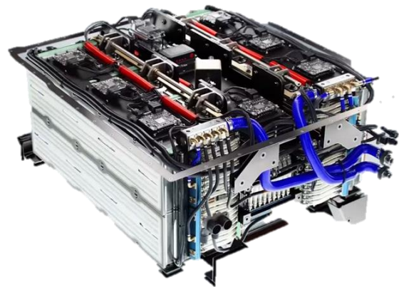
Obr. 57 BMW formule-E baterie – sezóna 2020 – ZDROJ: obrázky GOOGLE
