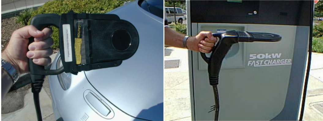
Obr. 16 Bezdrátové nabíjení založené na induktivní vazbě – ZDROJ vlevo[48], vpravo [49]
