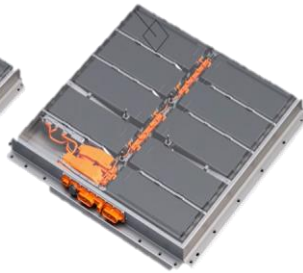
Obr. 55 Škoda ANYAQ iV baterie (různé verze) - ZDROJ [59]
