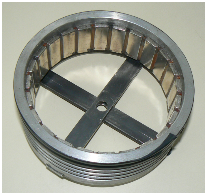
Obr. 50: Klasický rotor funkčního vzorku BLDC stroje
