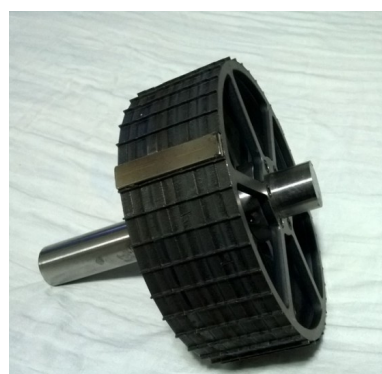
Obr. 7: Klasická konstrukce rotoru (upraveno z [20])
