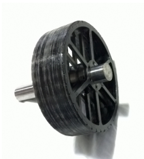
Obr. 8: Rotor klasické konstrukce s magnety upevněnými pomocí kompozitových bandáží (upraveno z [20])
