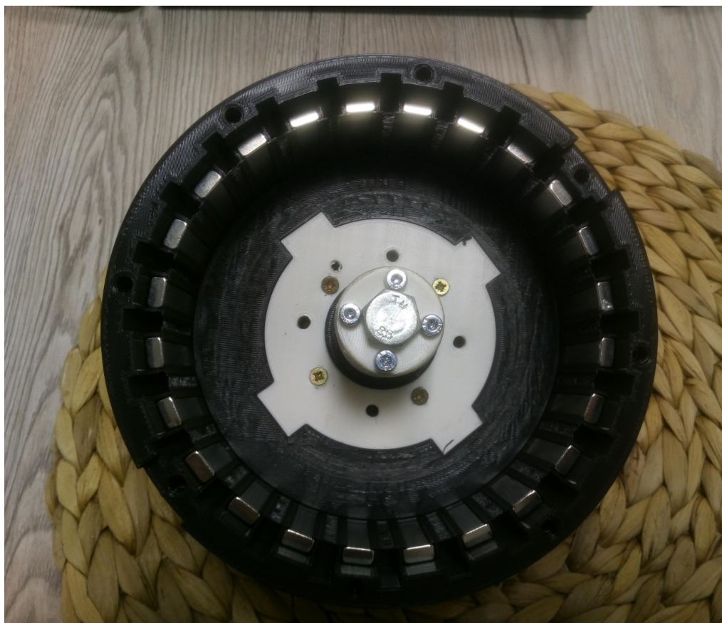
Obr. 53: Plastový rotor částečně osazený permanentními magnety
