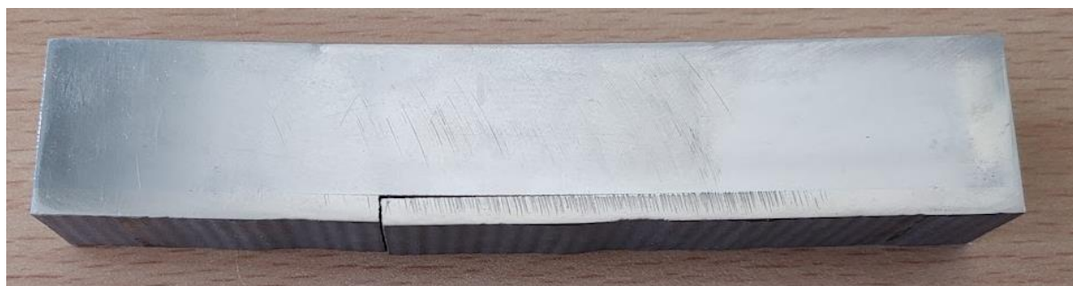
Obr. 1: Fotografie zkušebního tělesa s povlakem z Ni prášku s lomem a odtržením povlaku na jeho rozhraní se substrátem
