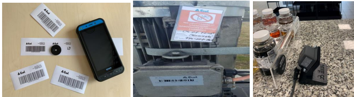
Obr. 5: Ukázka štítků, RFID a NFC prvků pro online zprávu a realizaci mazacích činností
